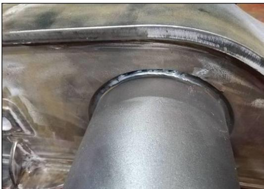
圖 3-58 轉向架組件焊接-1
