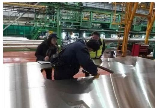
圖 3-67 側邊結構總成尺寸抽驗量測
