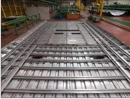
圖 3-86 車頂結構總成施工
