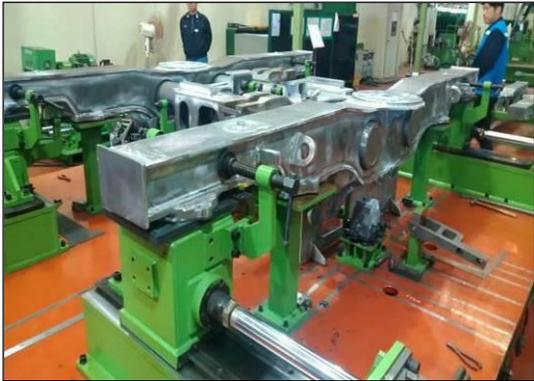
圖 3-19 轉向架結構施工介紹
