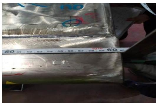
圖 3-73 車底結構總成 2 尺寸抽驗量測
