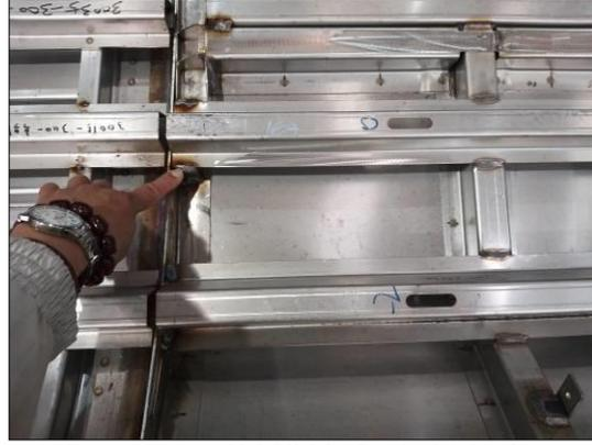
圖 3-87 車頂結構總成尺寸量測
