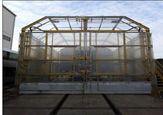
圖 4-2 進行水密試驗測試
