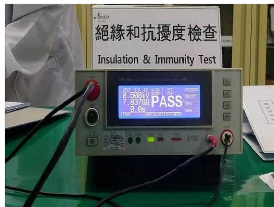
圖 5-14 TCMS 設備電壓抗擾性量測
