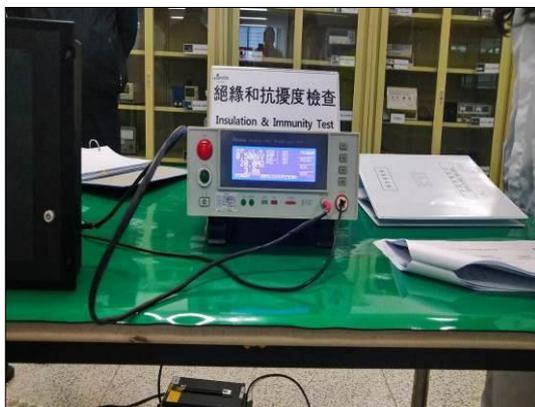
圖 5-13 TCMS 設備絕緣阻抗量測
