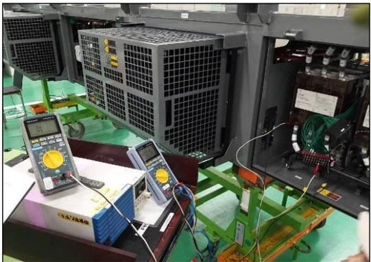
圖 3-39 MCOK3 跳脫電壓 43V
