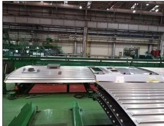
圖 3-89 車頂結構總成尺寸量測
