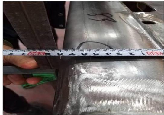
圖 3-61 車底框架結構總成尺寸抽驗量測
