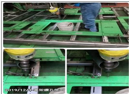
圖 3-57 車架鑽孔施工
