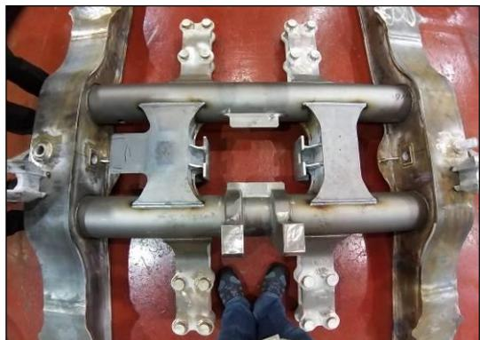
圖 3-59 轉向架組件焊接-2
