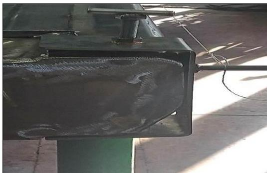
圖 3-74 車底結構總成 2 尺寸抽驗量測
