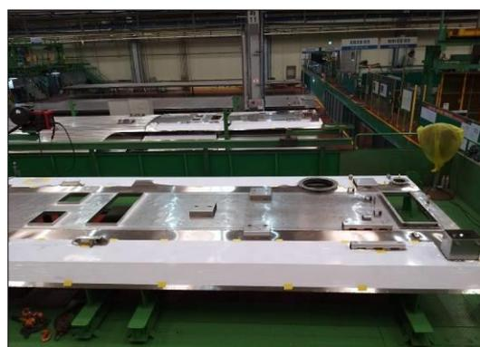
圖 3-81 車頂框架結構焊接施工-2
