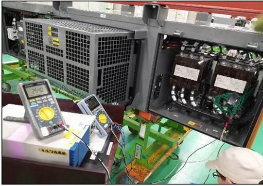
圖 3-37 MCOK4 線圈電阻量測
