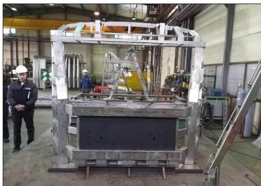
圖 3-92 駕駛室結構總成尺寸量測
