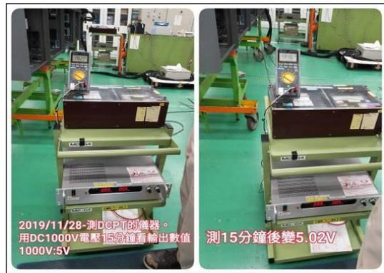
圖 3-40 DCPT-1 測試
