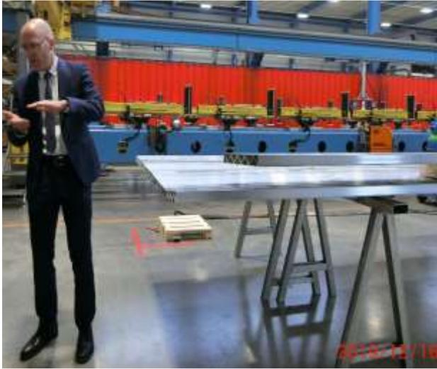
圖 24 鋁合金板擠壓出之三角中空箱型斷面
