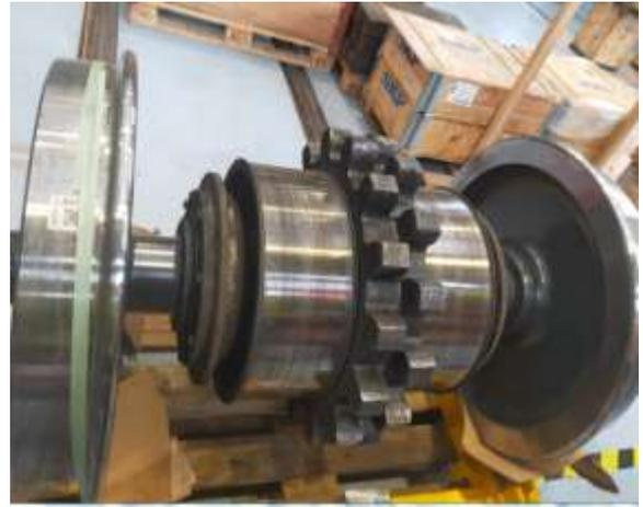
圖 89 MGB 冰河列車齒軌馬達構造
