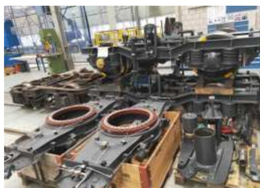
圖 53 MGB 轉向架拆解保養放置有序
