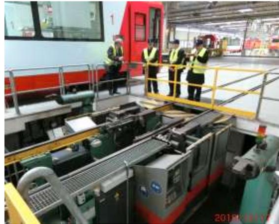
圖 55 廠長解說車輪旋削專用 NC 車床
