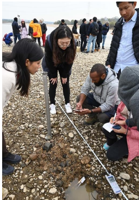
圖 33 量測河川溶氧量
