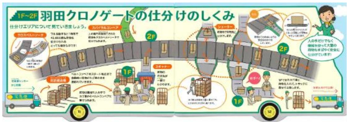
圖 17 包裹在履帶上運行流程【5】
