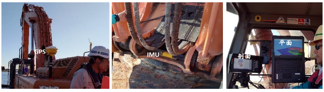
圖 71 ICT 施工設備
