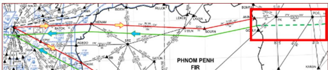
一直以來孟加拉灣的航情因為監控能力較弱，隨著 ADS-B 的共享機制，加上性能導航及平行航路的設置而促使該區航情能夠顯著改進，例如目前在空域設計上的 BIMT (Bangladesh, India, Myanmar and Thailand) 平行航路，主要是在原 L507 建構東西向的平行航路，爾後再仰光到曼谷 FIR 再細分東西向，藉由一步步的規劃來改善航路加大容量進而增進效率。
