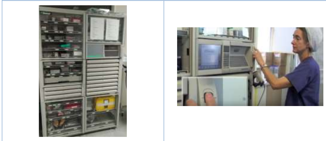
墨爾本皇家醫院使用的自動化藥櫃 ADC (Automatic Dispensing Cabinet) 自動化藥櫃 (截圖自 Omnicell Automated Dispensing Cabinets)
