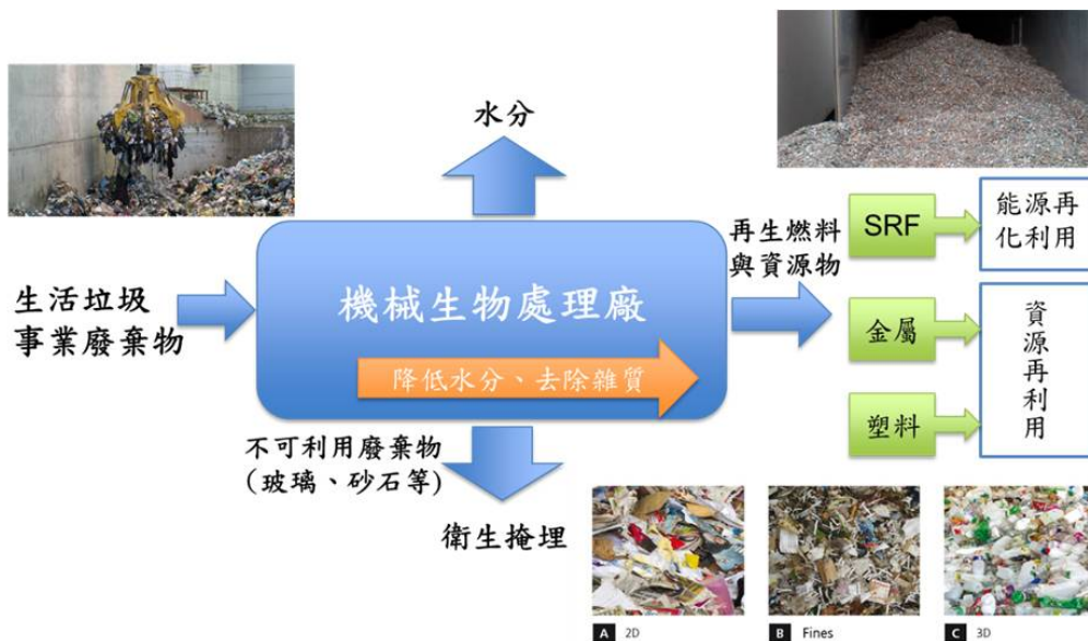
圖 3-18 廢棄物機械生物處理能資源化示意圖 [12]
