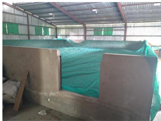
圖 12. 稻穀乾燥設備-烘乾槽
