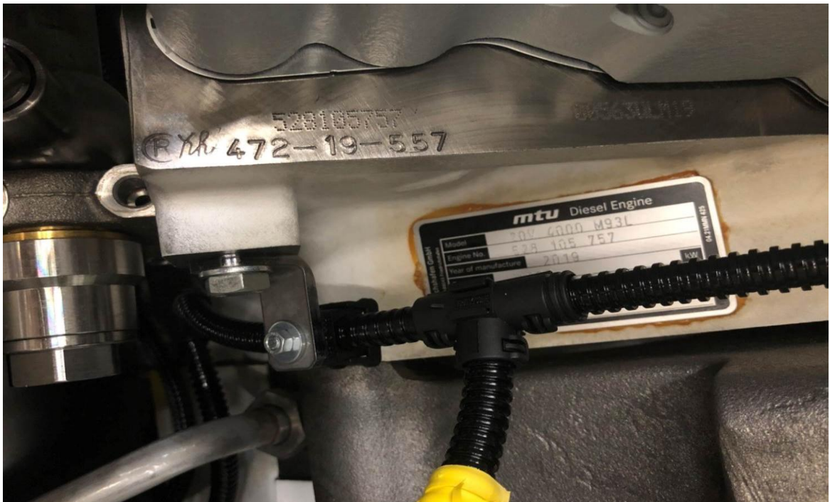
(圖 9: 第一部 20V 主機 (527 116 757) CR 鋼印及銘牌)
