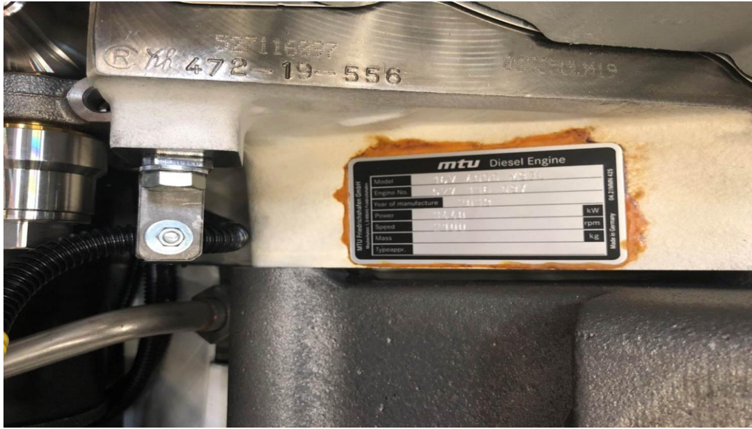
(圖 6: 第一部 16V 主機 (527 116 097) CR 鋼印及銘牌)
