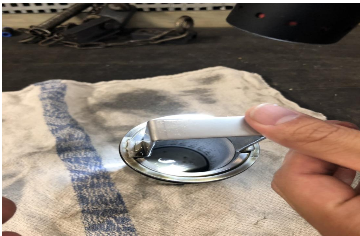
(圖 11: 主機滑油濾器拆下檢查)
