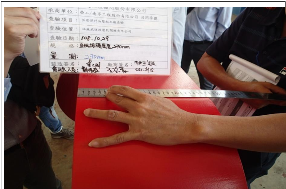
日期：108.10.29 尺寸檢查:魚眼接頭尺寸檢查(一) 地點：武進液壓啟閉機公司製造廠
