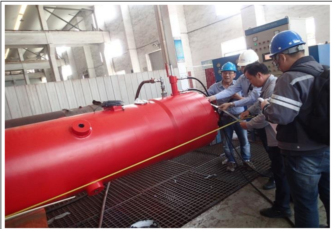
日期：108.10.29 尺寸檢查:油壓缸尺寸檢查(二) 地點：武進液壓啟閉機公司製造廠
