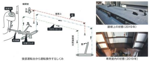
後部運転室から運転操作するしくみ
