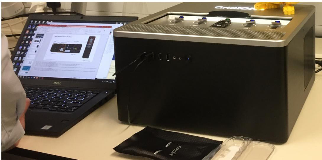
圖二、以高通量奈米檢測儀(GridION)同步進行基因解讀。
