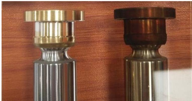
柱塞泵內部銅元件(活塞)，左：正長，右：腐蝕
