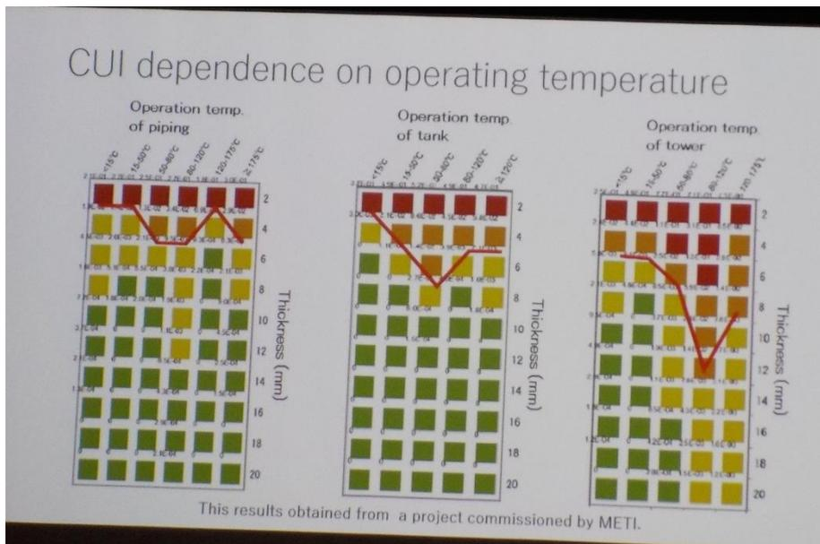
圖 11 旭化成的 CUI 統計分析結果-不同設備位置發生 CUI 的腐蝕深度
