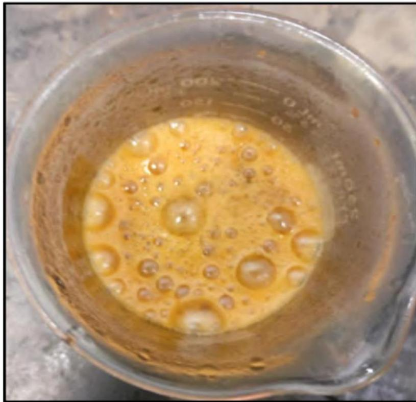
圖十五、Bench top reaction 中熱化學流體與蠟固體反應情形
