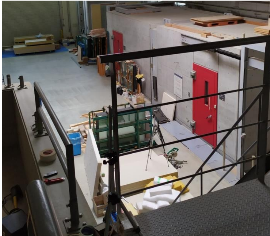
圖 20. 符合 JIS A1416 TYPE II 迴響室(共 6 間)
