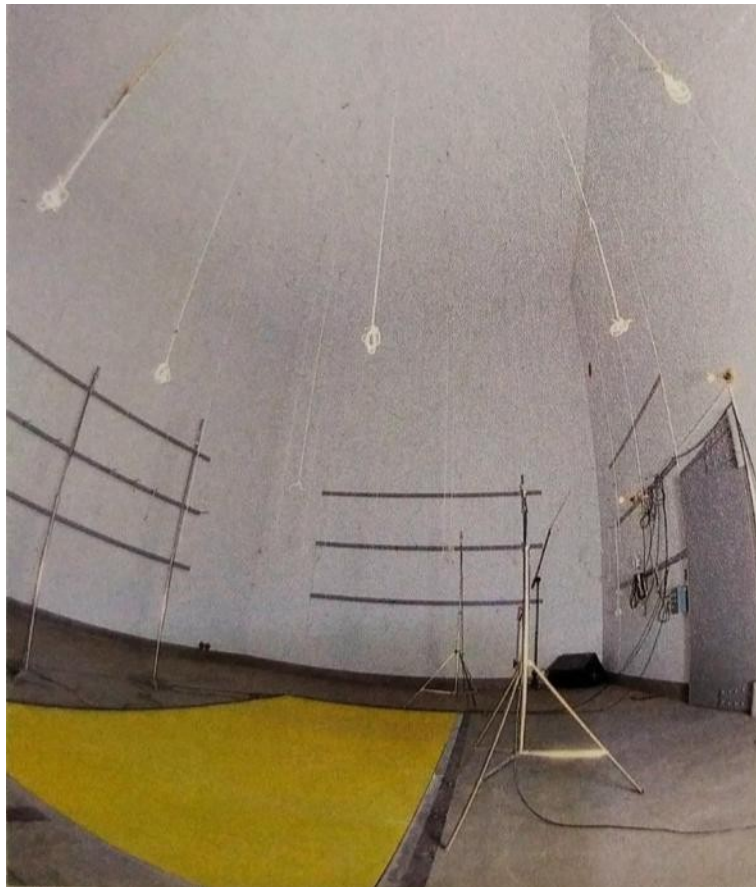
圖 23.日本 1955 年第 1 座建置 JIS A1416 TYPE I 迴響室(513m 3 )
