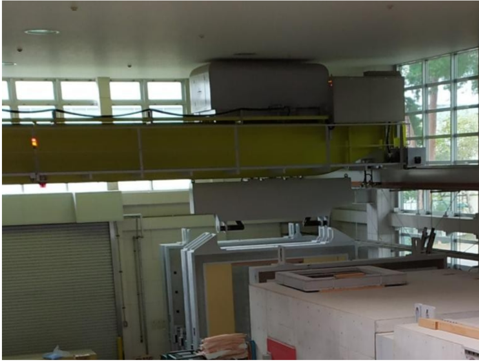
圖 22 利用吊掛系統運送測試件
