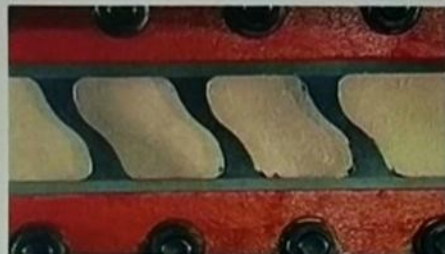
制震ダンパ (ハニカムダンパ) の加力実験 Loading Test of Honeycomb Damper
