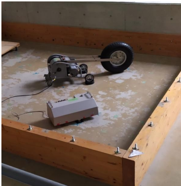
圖 21 樓板衝擊音隔音性能測試迴響室及衝擊音音源 (以整棟建築物為音源室)
