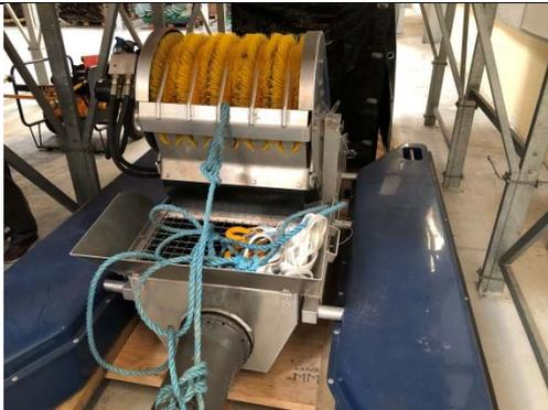
圖 4.2-19 下水式刷式汲油器
