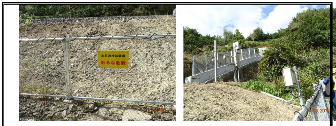
圖 3-35 土石流告警系統
