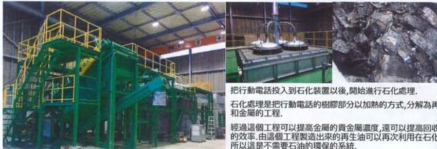
把行動電話投入到石化裝置以後，開始進行石化處理。石化處理是把行動電話的樹脂部分以加熱的方式，分解為再生油和金屬的工程。經過這個工程可以提高金屬的貴金屬濃度，還可以提高回收再生的效率。由這個工程製造出來的再生油可以再次利用在石化處理，所以這是不需要石油的環保的系統。
