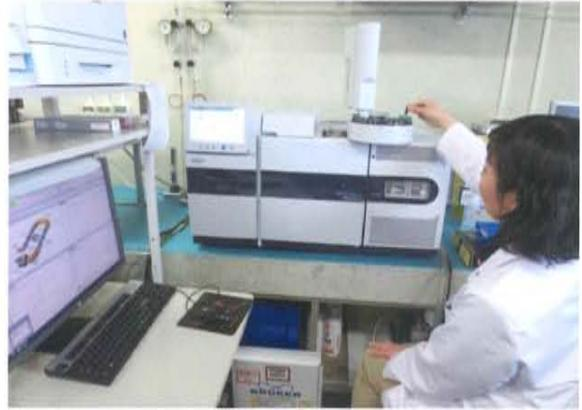
GC-MS/MSを用いた食品中の残留農薬検査
