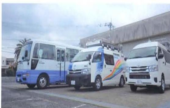
左から順に、煙道排ガス測定車、大気環境測定車、放射線モニタリングカー
