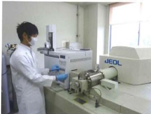
高分解能ガスクロマトグラフ質量分析計によるダイオキシン類の測定
