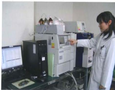
高速液体クロマトグラフ質量分析計による有害化学物質の測定
