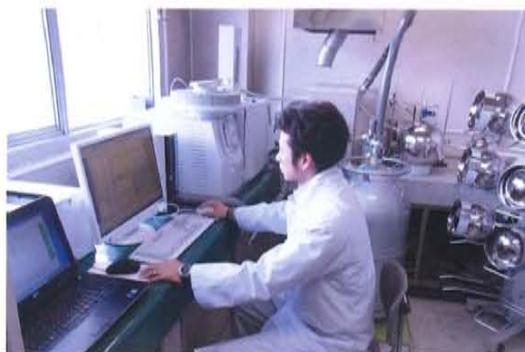
キャニスターGC-MSを用いた有害大気汚染物質の測定
