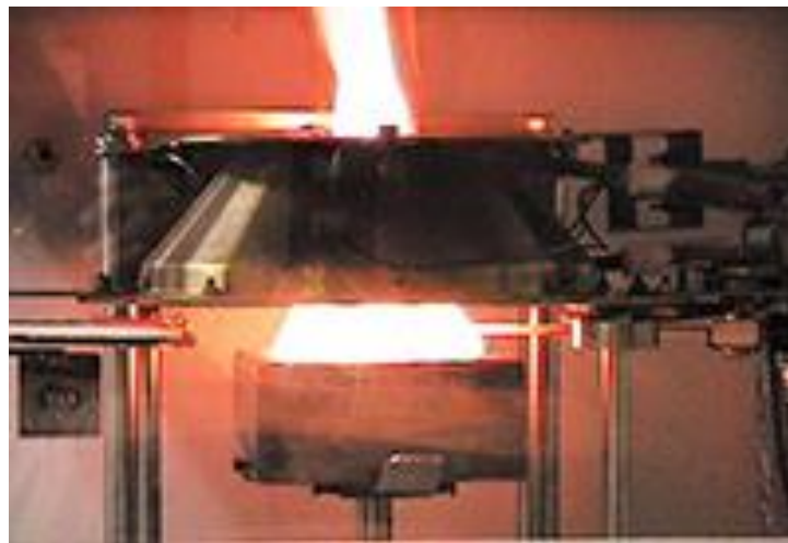
圖 7 圓錐量熱儀耐燃實驗
