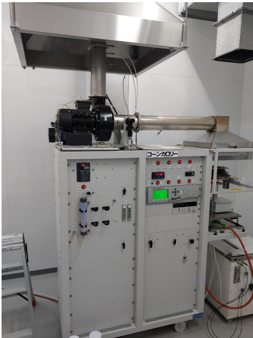
圖 3 耐燃實驗室及圓錐量熱儀
