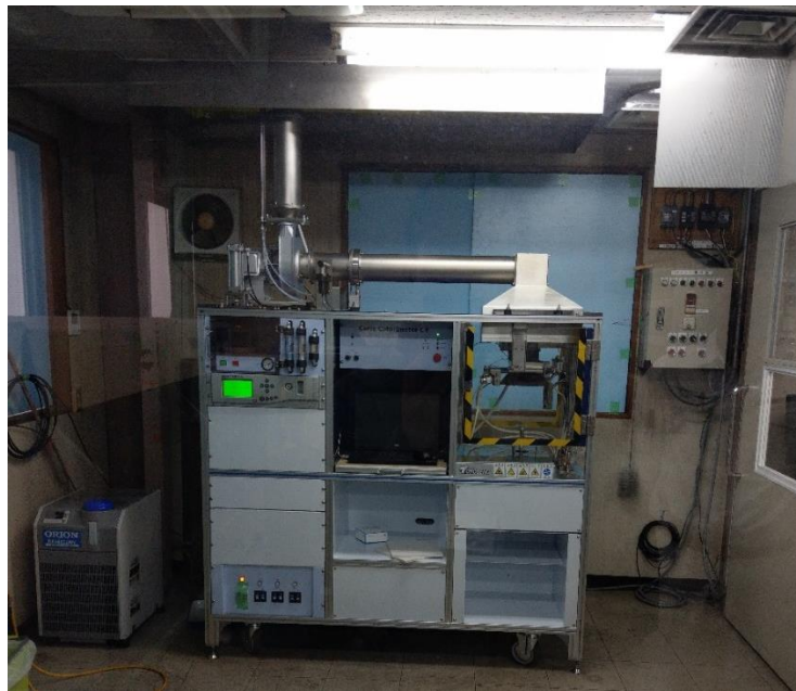
圖 6 耐燃實驗室及圓錐量熱儀
