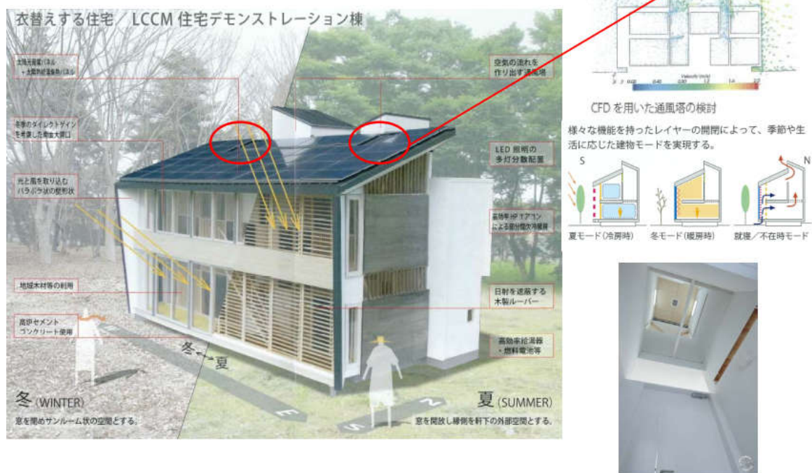
圖 24 LCCM 示範屋針對夏冬兩季設設置的不同設備，以維持室內舒適度， 被稱為會換衣服的住宅(日本建研所)
