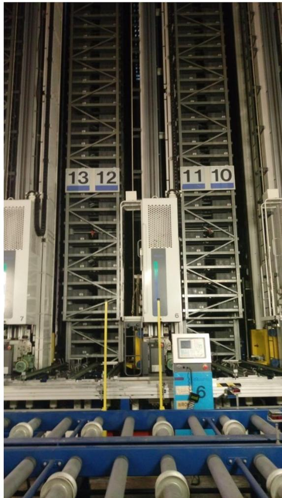
圖 3-2-28 地下維修站之地下自動倉庫系統
