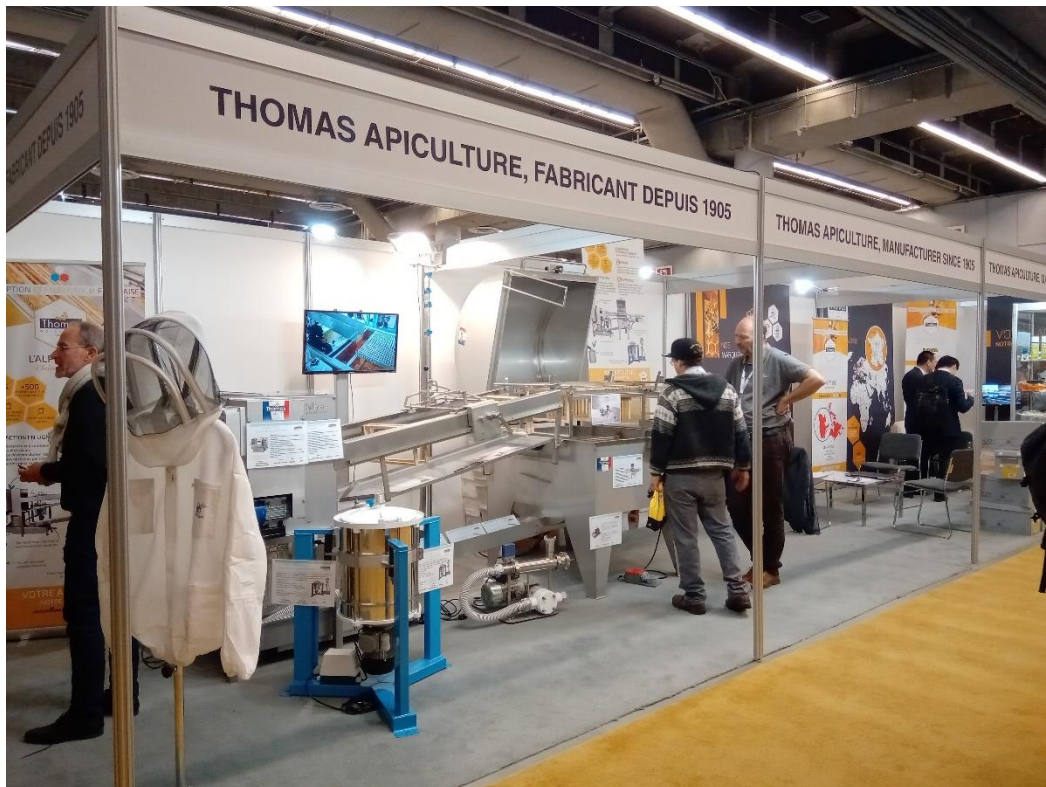
圖八、展示會場展示連續型自動搖蜜機，以輸送帶傳動蜜脾，自動割除封蓋蠟並搖蜜。
