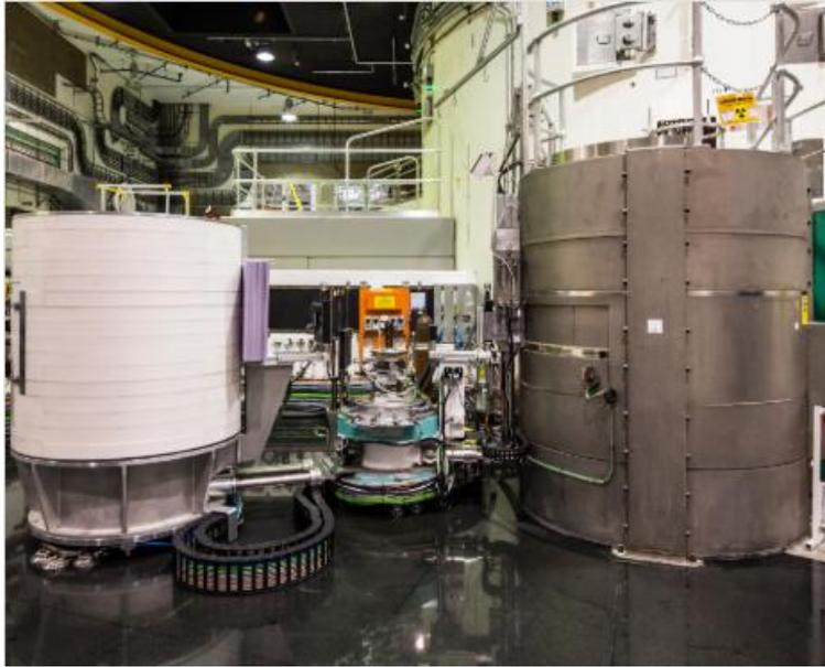
圖 28、SIKA-project 冷中子三軸散射實驗站
