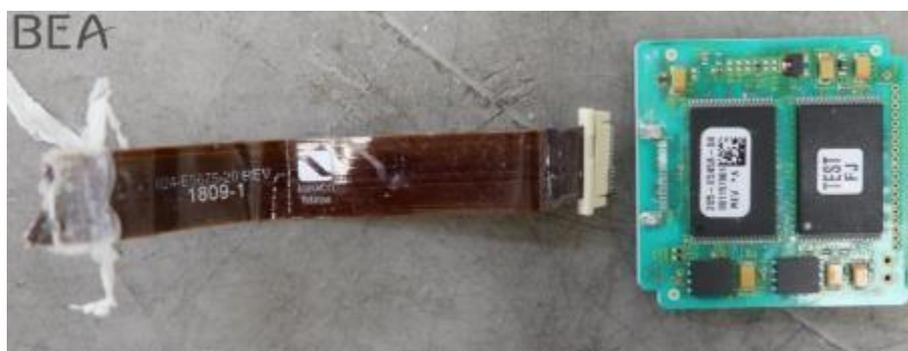
圖 3.1-2 資料下載排線與 NAND 記憶體單層電路板外觀
