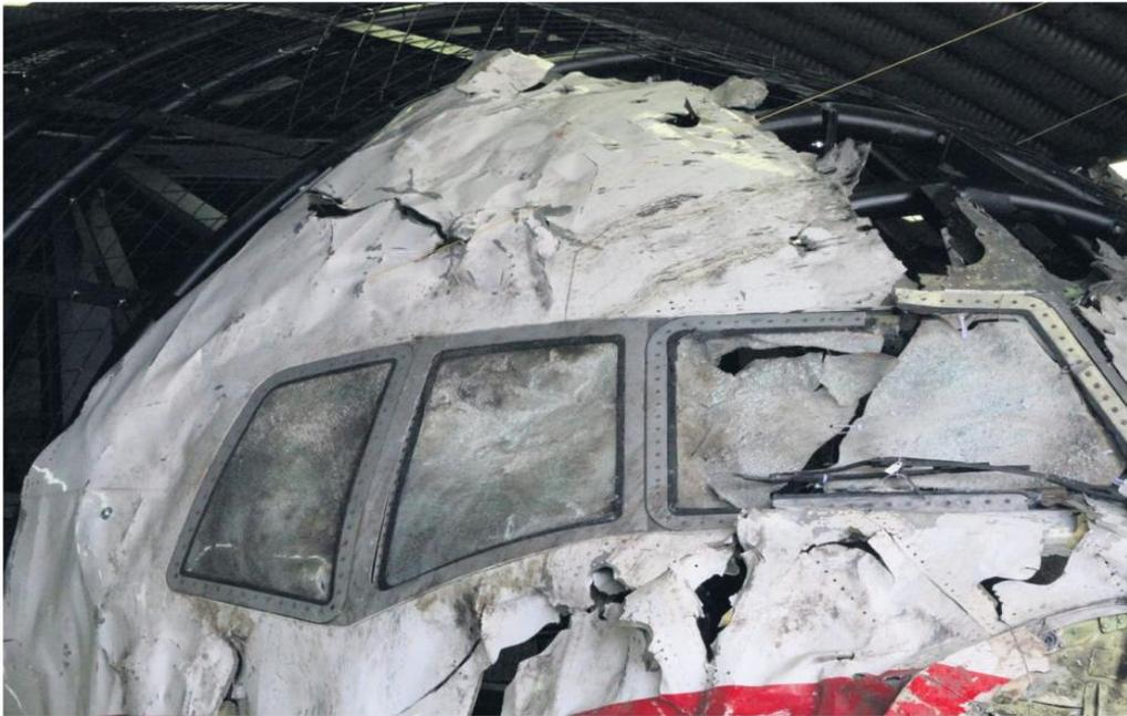
圖 10 MH17 航班之機頭殘骸重建圖（包含孔洞與跳彈痕跡）
