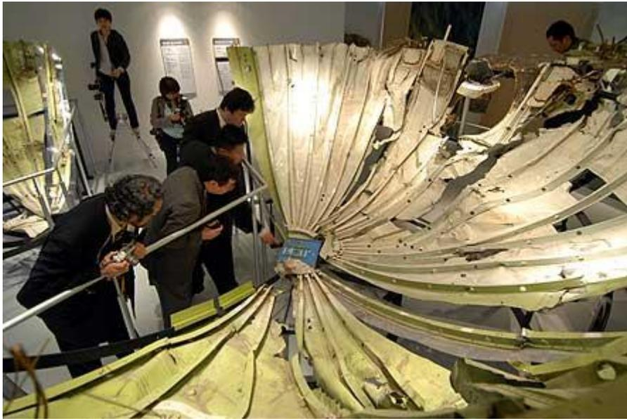
圖 5 JAL 123 主殘骸（後加壓艙面板）外觀圖
