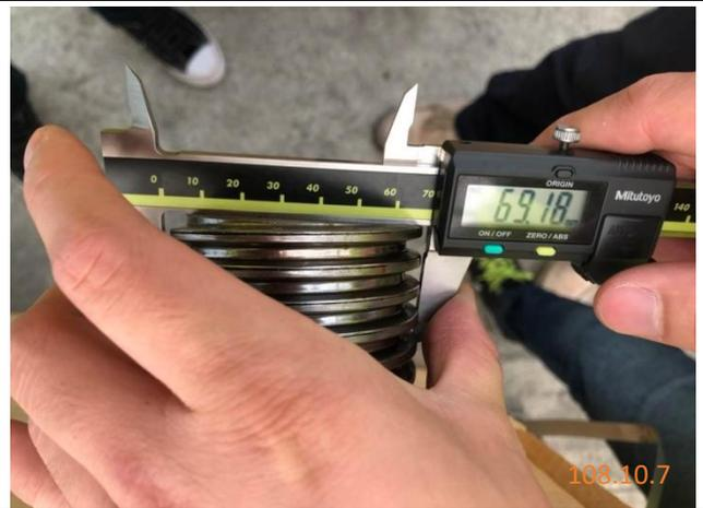
圖 44: 4.0 尺寸檢查:4.1 轉向架頂升機舉升螺桿
