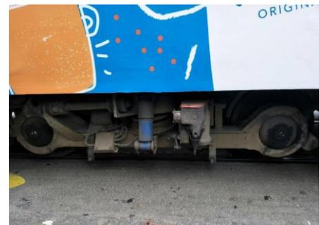
圖 82:2 節式輕軌電車轉向架
