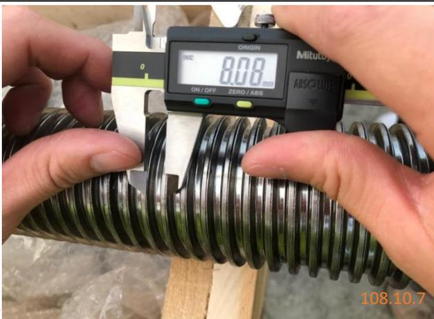
圖 45: 4.0 尺寸檢查:4.1 轉向架頂升機舉升螺桿
