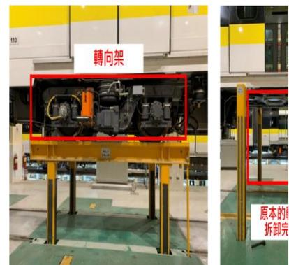
圖 4: 頂升設備將轉向架升起以利拆卸
