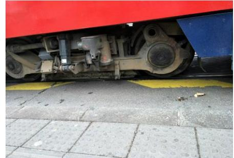
圖 80:4 節式輕軌電車轉向架
