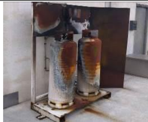
圖 38：瓦斯桶火災模擬設施
