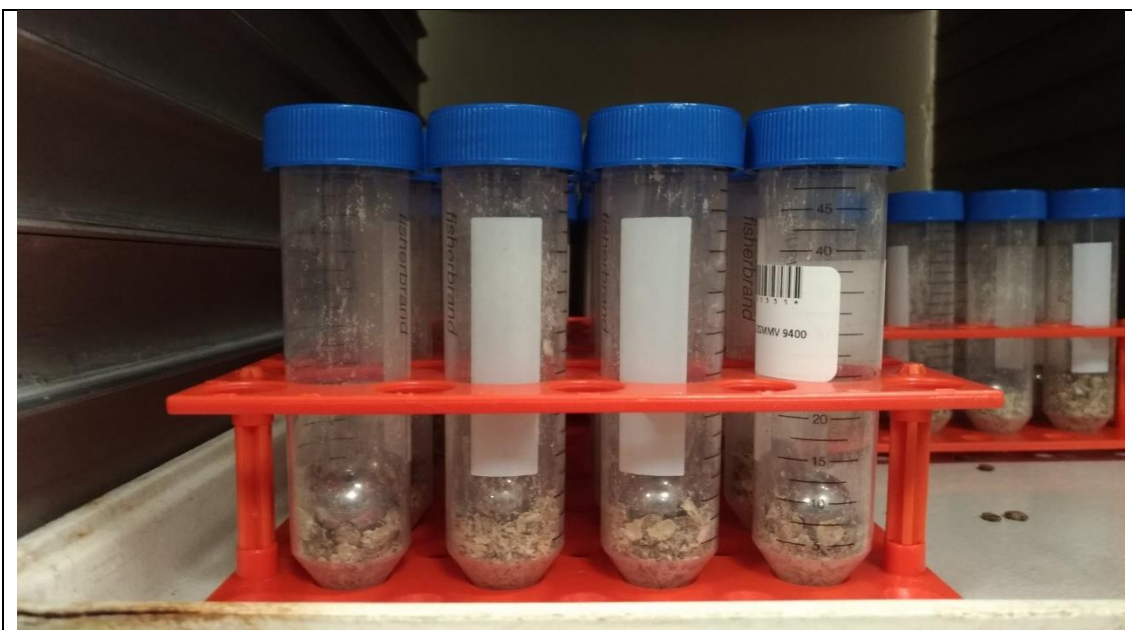
圖 11、種子科學中心使用鋼珠研磨種子
