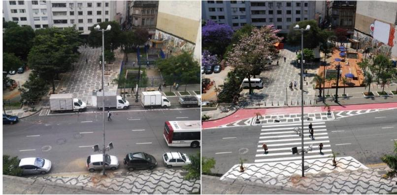
圖18 移除停車位增設自行車道及縮短行人穿越距離之案例
