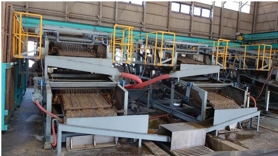
圖 25.日本原料公司高萩工廠濾砂篩洗機
