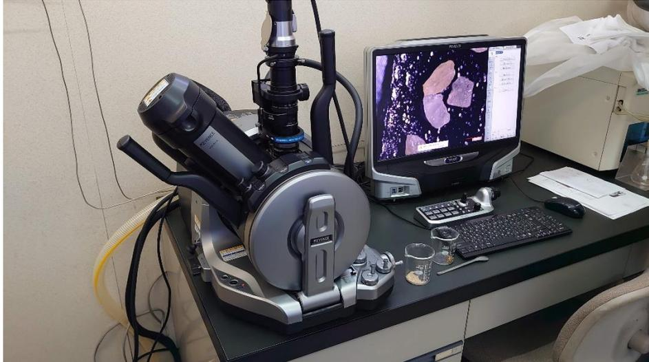
圖 28.高倍率顯微鏡觀察濾砂
