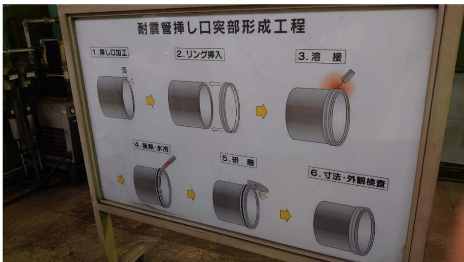
圖 46.耐震管承口突部形成工程
