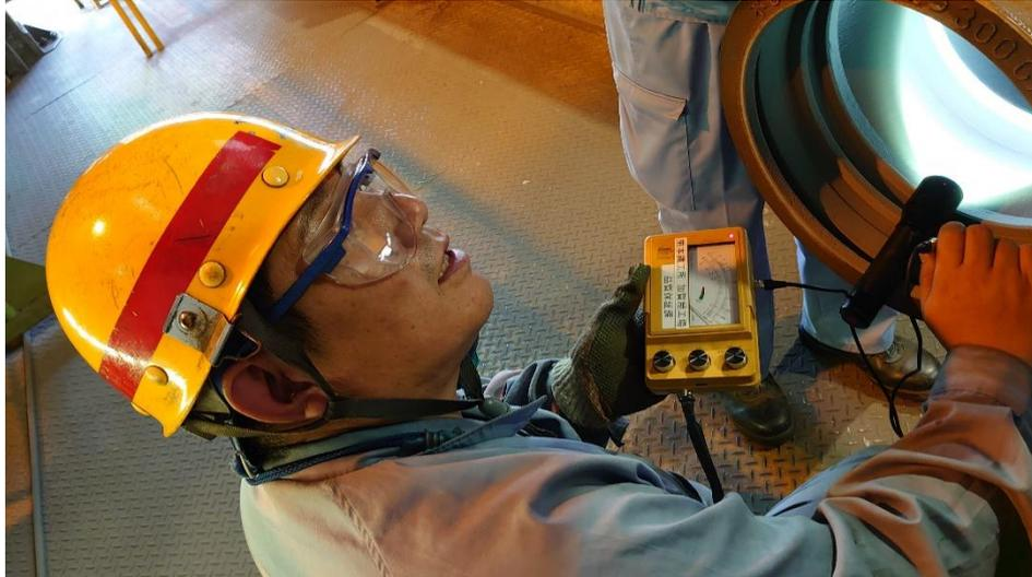
圖 49.內面粉體塗裝膜厚檢測
