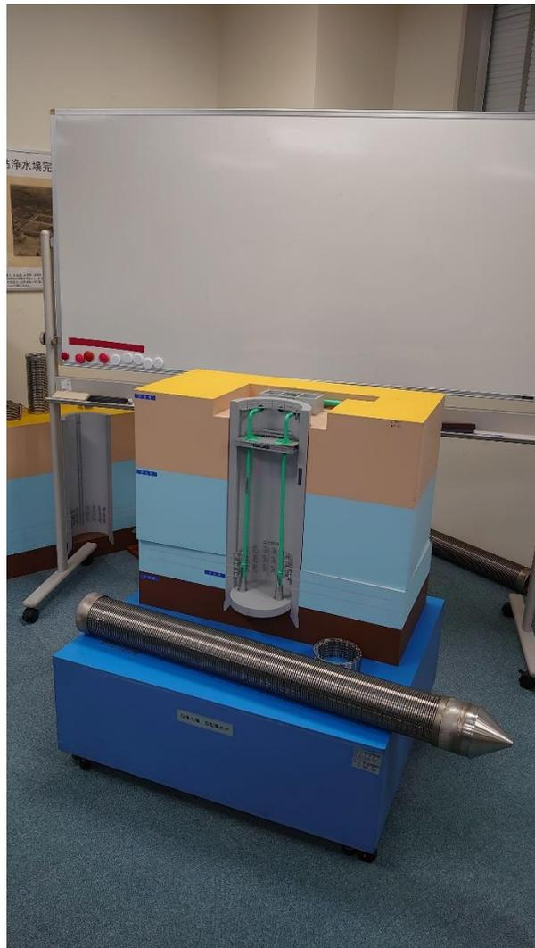
圖 9.伏流水取水井及集水管模型
