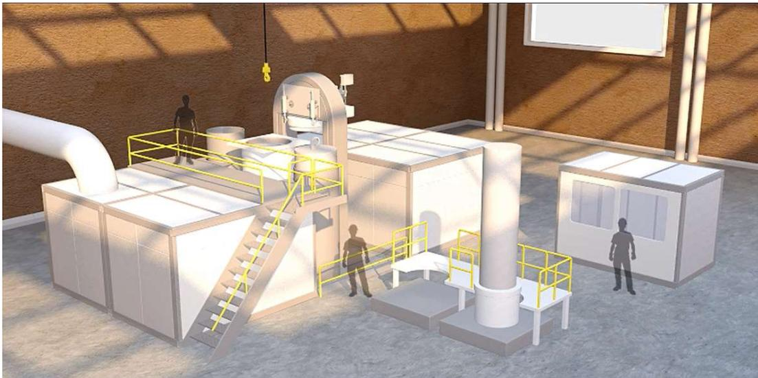
圖 3 熱均壓設備在準備作業中，保護框架需連同上封蓋一同移出。
