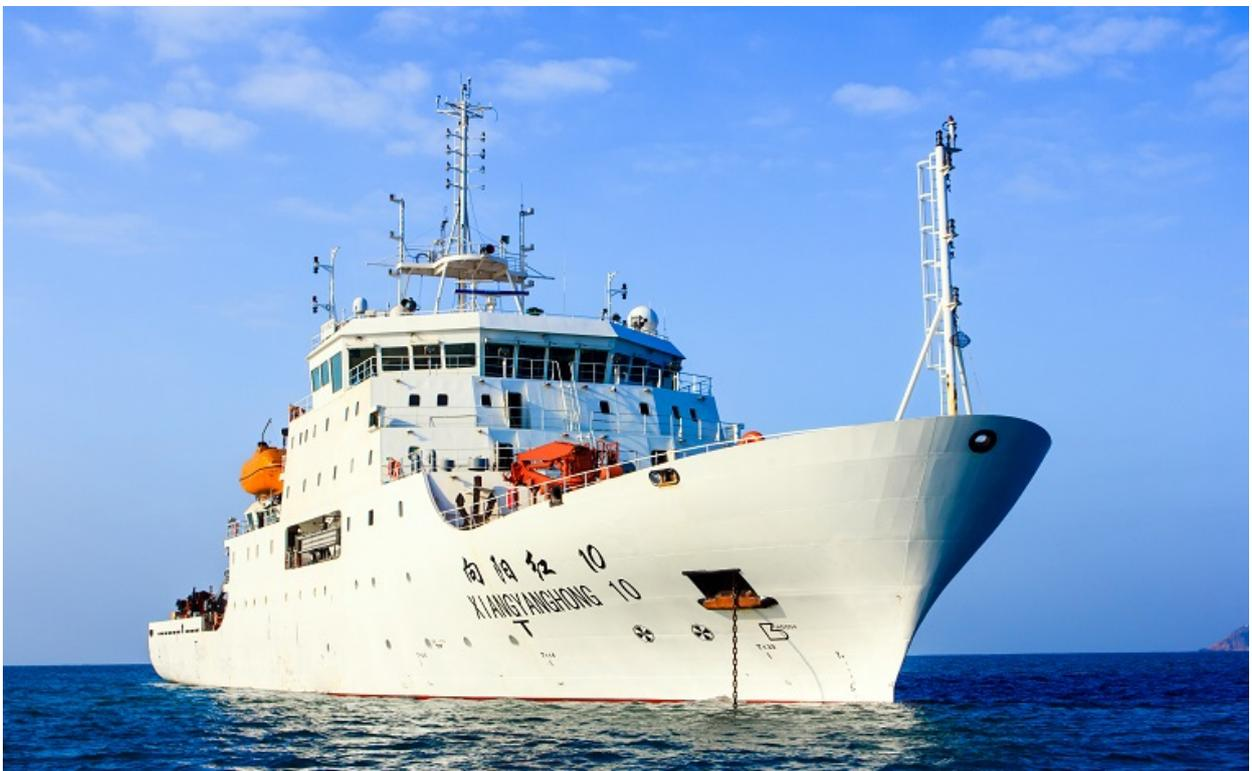
圖 6、中國大陸 4,500 噸級的「向陽紅 10 號」海洋綜合研究船(該船於 2014 年建造完成)，總長 93 m，寬 17.4 m，為中國大陸現今大洋海底礦產調查的主力船。圖片來源: 中國大陸自然資源部第二海洋研究所網站。
