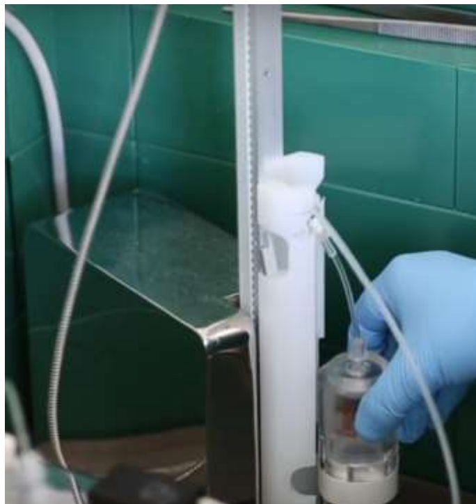
圖100、義大利廠牌TEMA的核醫藥物分裝裝置，將預備給病患使用的核醫藥物容器至於右側的輻射劑量校正儀。(照片為作者於巴特貝爾卡中央醫院拍攝)
