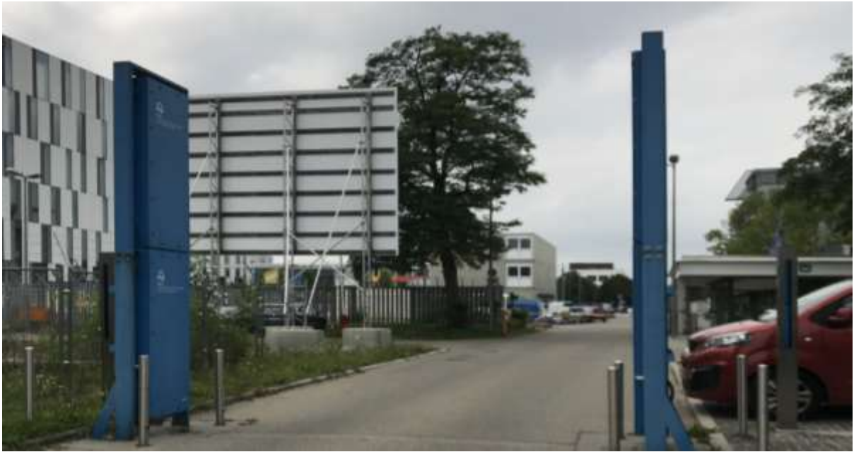
圖13、TUM管制區進出道路之車輛輻射偵檢器。(照片為作者於TUM拍攝)
