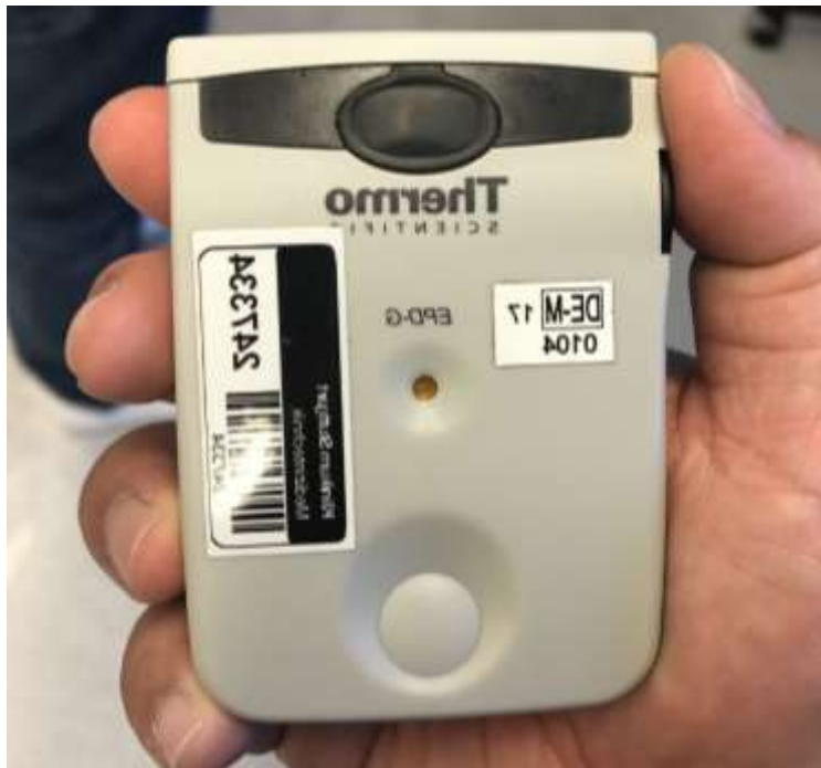
圖62、進入核醫藥局前，須先登記並配戴個人輻射偵檢器。(照片為作者於凱薩琳醫院拍攝)
