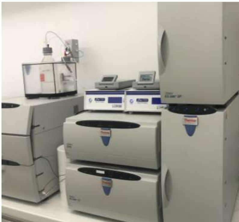
圖 118、巴特貝爾卡中央醫院核醫藥局所使用的離子層析儀，型號 Thermo Scientific Dionex™ ICS-5000。(照片為作者參訪巴特貝爾卡中央醫院時拍攝)
