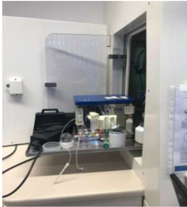
圖64、凱薩琳醫院的鉛櫃與iQS-TS系統。這一組是專用於標誌Lu-177-DOTATOC或是Lu-177-PSMA所使用，鉛櫃的側門加上滑動槽設計，讓操作者可在外部完成耗材組與試劑組的安裝，再推動滑動槽至鉛櫃內完成後續反應步驟，對周圍醫事人員的輻射暴露降到最低。(照片為作者參訪凱薩琳醫院時拍攝)
