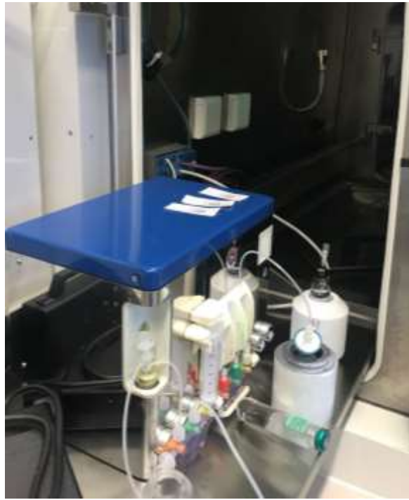
圖84、作者於凱薩琳醫院實際操作iQS-TS，試劑調配並組裝好以後，準備推入鉛櫃開始標誌反應。(照片於凱薩琳醫院拍攝)
