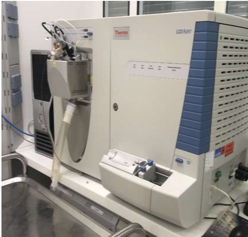
圖 119、巴特貝爾卡中央醫院核醫藥局所使用的離子阱質譜儀，型號 Thermo Scientific LCQ Fleet Ion Trap LC/MS。(照片為作者於巴特貝爾卡中央醫院拍攝)
