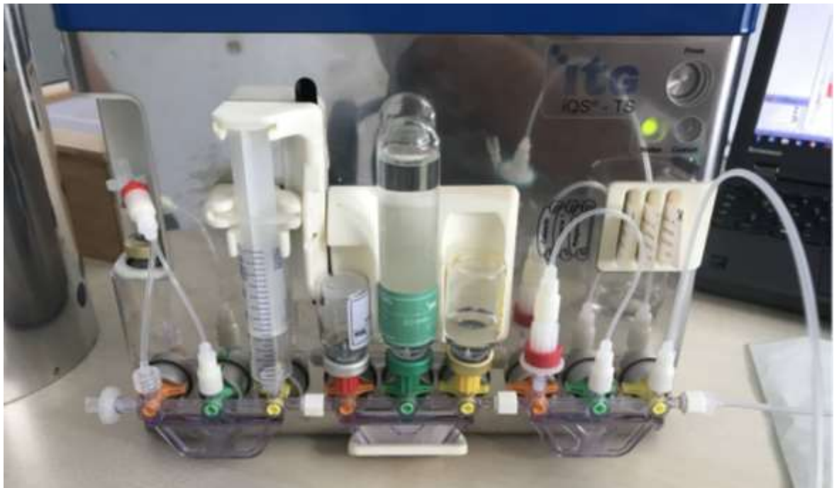
圖50、裝載完試劑組與Ga-68耗材組，三個卡榫明顯與Lu-177耗材組相異，作者於ITG實驗室進行Ga-68-DOTATOC標誌cold-run模擬測試。
