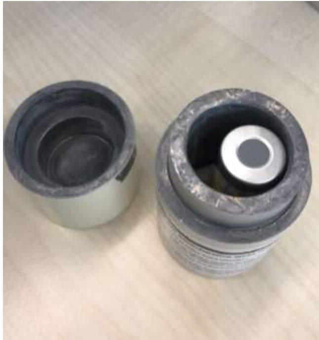
圖27、ITG EndolucinBeta ® 第二層包裝以一公分厚鉛罐包裝。(照片為作者參訪ITG實驗室時拍攝)
