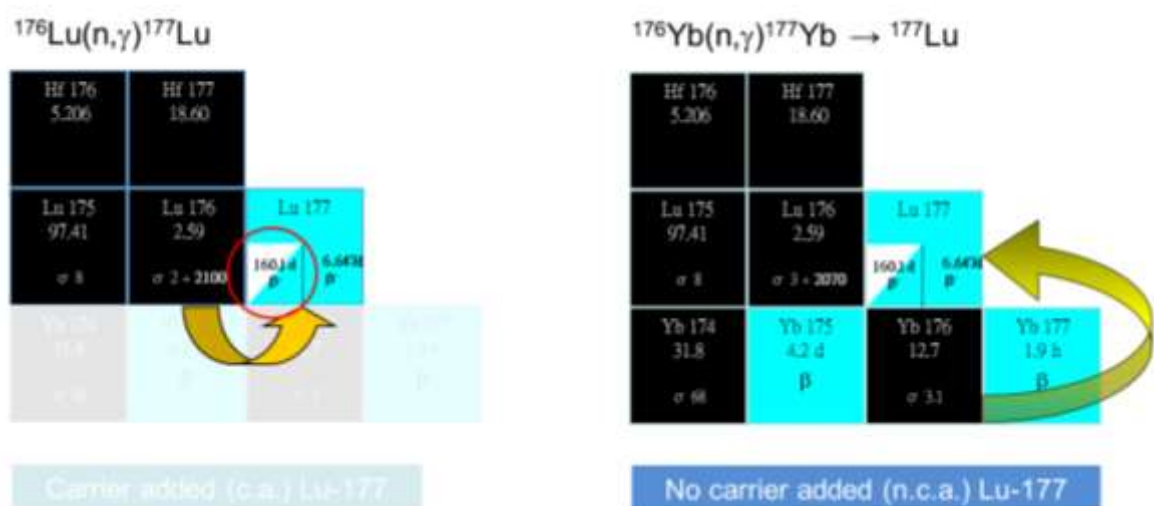
圖7、放射性同位素Lu-177可經由兩種反應途徑獲得，藉由Yb-176照射而獲得的n.c.a Lu-177具有較高應用價值，其產製、純化分離也具較高技術需求。ITG生產的n.c.a Lu-177比活度可達3,000 GBq/mg，其中所含的Lu-177m含量 < 10^{-5} \% 。(圖片摘錄自慕尼黑工業大學論文系統)
