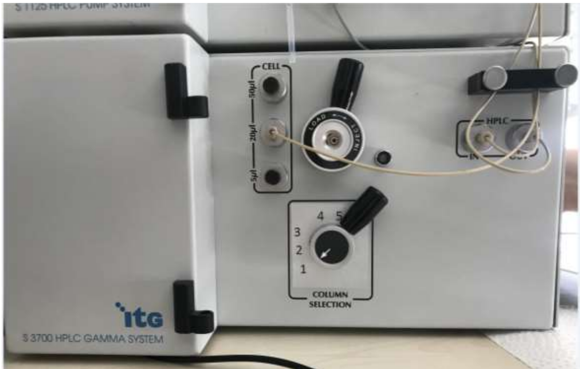
圖54、ITG radioHPLC可選擇進樣量，在Lu-177-PSMA的檢驗輸入25 \mu\text{L} 的樣品進行檢驗。(作者於ITG公司實地操作時拍攝)
