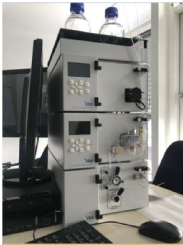
圖52、標誌完成進行基本的標誌效率測試，此為ITG radioHPLC，Lu-177-PSMA合格標準需大於99 %。(作者於ITG公司實地操作時拍攝)
