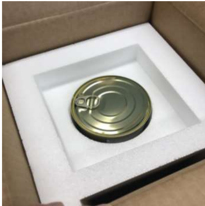
圖29、ITG EndolucinBeta ® 第四層包裝以保麗龍固定密封鐵罐包裝並裝入貨運紙箱。(照片為作者參訪ITG實驗室時拍攝)
