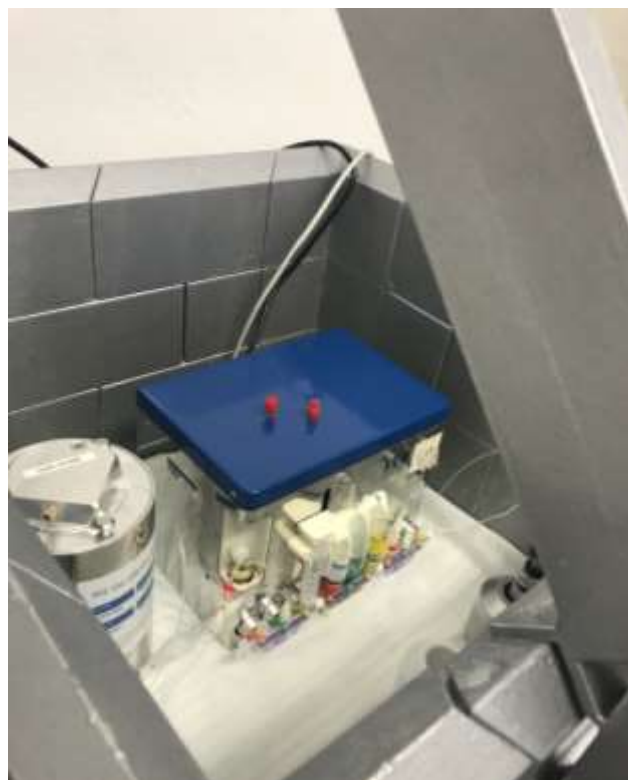
圖63、凱薩琳醫院的Ga-68發生器與iQS-TS系統。這一組是專用於標誌Ga-68-DOTATOC或是Ga-68-PSMA-11所使用，整組置至於鉛磚內、操作人員隔著鉛玻璃操作，儀器所佔空間需求小。(照片為作者於凱薩琳醫院拍攝)
