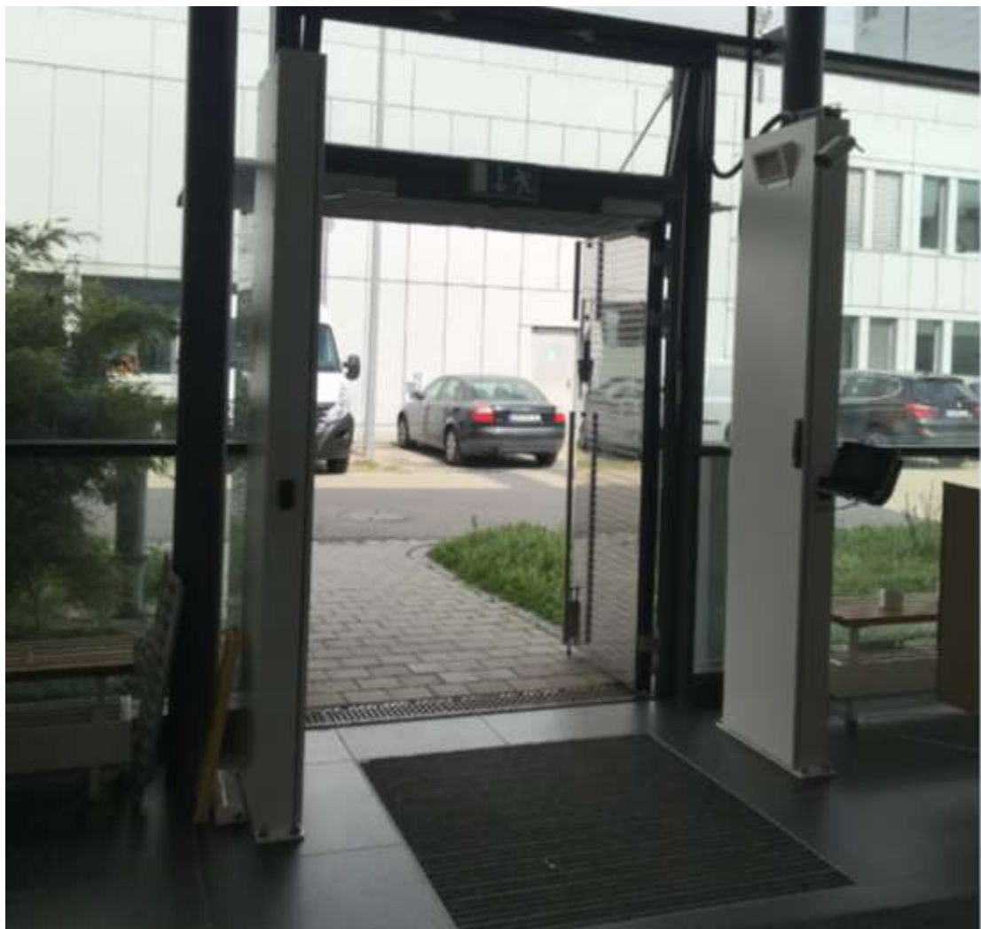
圖14、ITG實驗室入口之人員輻射偵檢器。(照片為作者於ITG實驗室拍攝)
