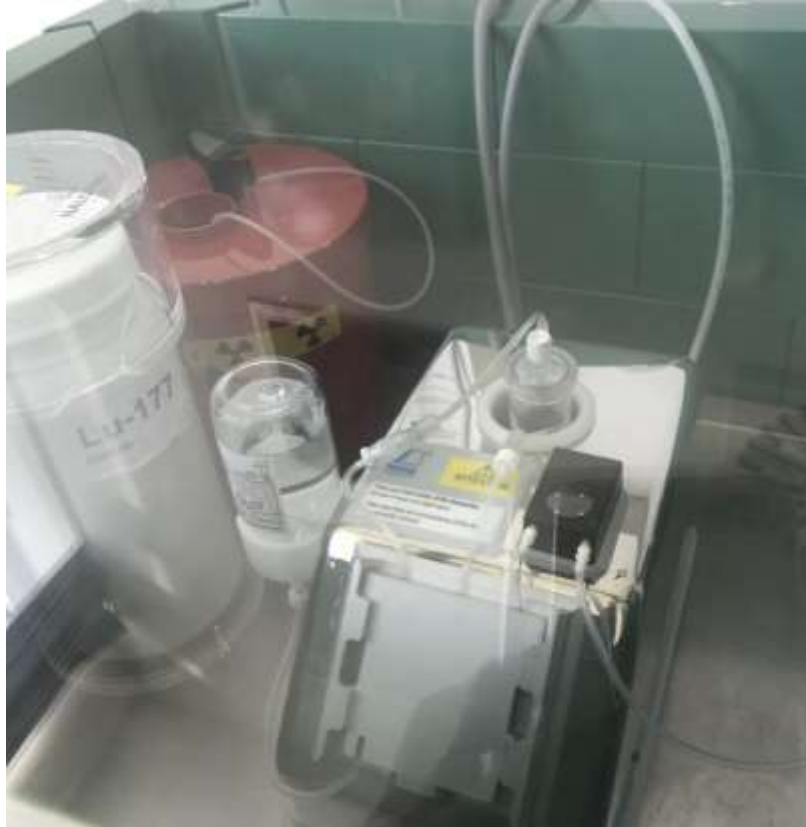
圖99、義大利廠牌TEMA的核醫藥物分裝裝置，將核醫藥局標誌完成的Lu-177-PSMA核醫藥物至於儀器中央凹槽。(照片為作者於巴特貝爾卡中央醫院拍攝)
