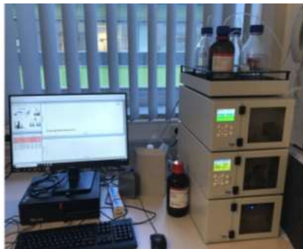
圖71、凱薩琳醫院核醫藥局之ITG radioHPLC，用於Lu-177-PSMA核醫藥物的放化純度檢驗，凱薩琳醫院以兩套系統並行確保標誌產物有達到99 %放射化學純度的合格標準。(照片為作者參訪凱薩琳醫院時拍攝)
