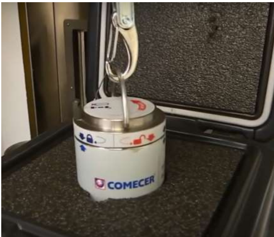
圖 124、裝載核醫藥物的鉛罐置入運送箱內，內部以泡棉固定避免翻覆。(圖摘錄自巴特貝爾卡中央醫院專訪影片)
