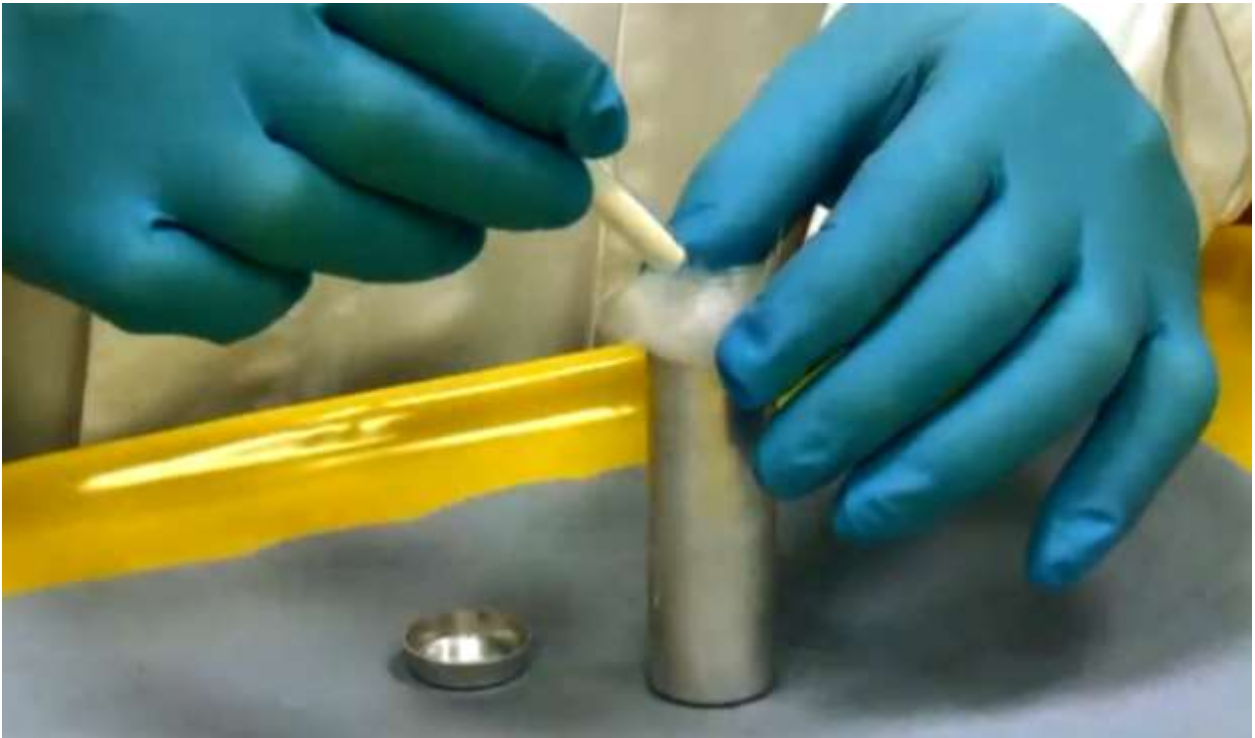
圖19、TUM研究人員將Yb-176安瓿瓶置入容器中。(圖片摘錄自ITG介紹影片)
