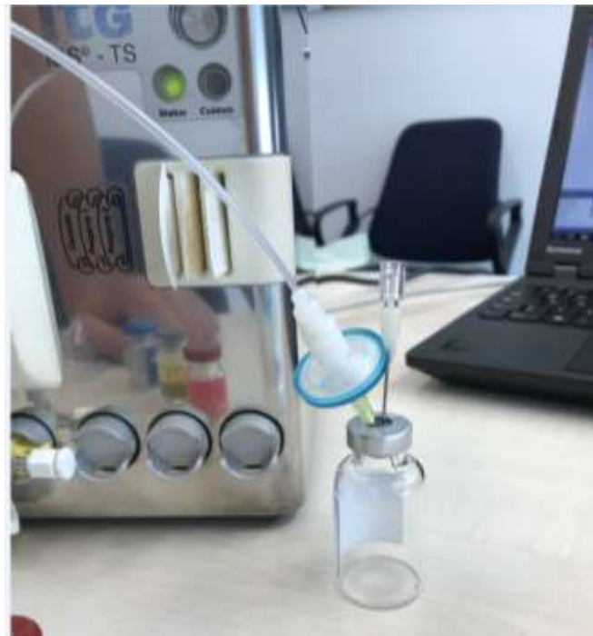
圖43、iQS-TS組裝完成的射源、耗材組與產品瓶，預備進行Lu-177核醫藥物標誌反應。藥物留至產品瓶前先經過一個藍色、0.22 \mu\text{m} 親水性濾膜作為最終滅菌步驟。(作者於ITG實驗室拍攝)
