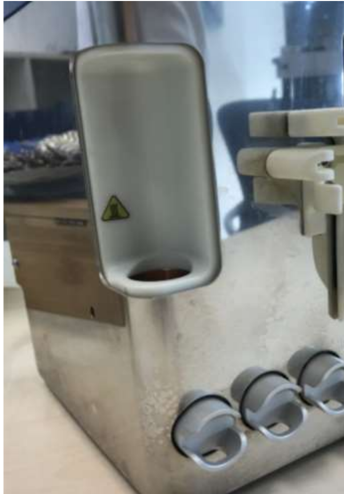
圖40、白色凹槽為反應槽，其以加熱器包覆並設有溫度偵測器，儀器內後方並設置有輻射偵檢器可偵測相對活度。(作者於ITG實驗室拍攝)
