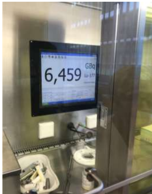
圖79、凱薩琳醫院核醫藥局內的輻射劑量校正儀，檢測剛標置完畢的Lu-177-PSMA核醫藥物活度，每位病患接受的劑量範圍約為6~8 GBq。(照片為作者於凱薩琳醫院拍攝)
