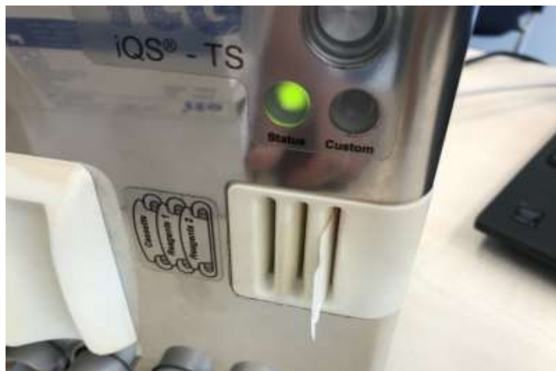
圖41、RFID條碼插槽，確保使用者所使用的耗材組、試劑組與胜肽藥物來源皆來自於ITG合格供應貨源。(作者於ITG實驗室拍攝)
