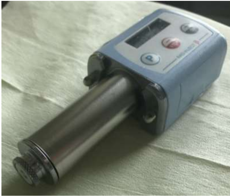
圖105、義大利廠牌TEMA的輻射藥物微型注射器RAD-INJECT，其使用2公分厚的鎢材質作為屏蔽，可將周圍的輻射暴露降至 \mu\text{Sv/h} 。(照片為作者於巴特貝爾卡中央醫院拍攝)
