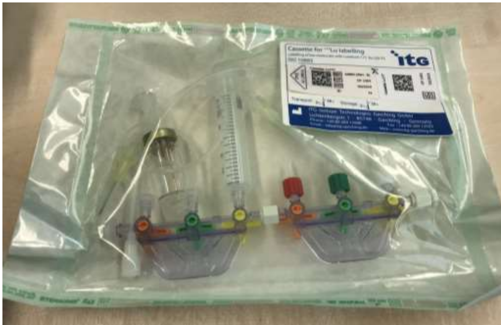
圖38、Lu-177標誌耗材組，下方有兩個卡榫，與Ga-68耗材組的三個卡榫有明顯區別，用以減少安裝時人為造成的失誤。(作者於ITG實驗室拍攝)
