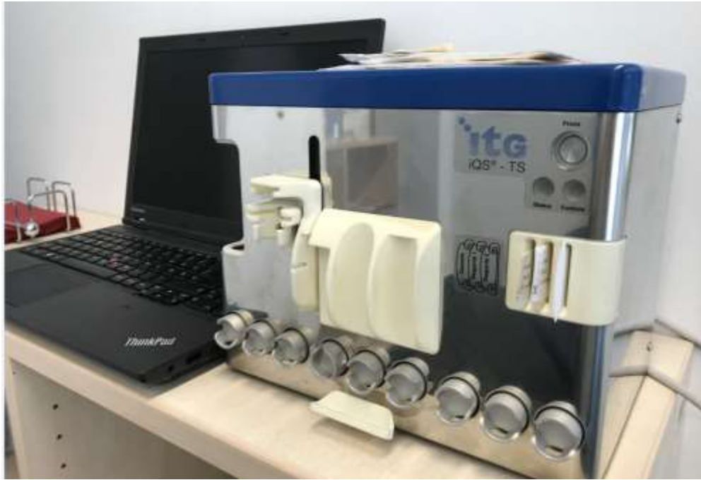
圖37、iQS-TS空機樣式，耗材組與試劑組須每次標誌時安裝、調配。(作者於ITG實驗室拍攝)
