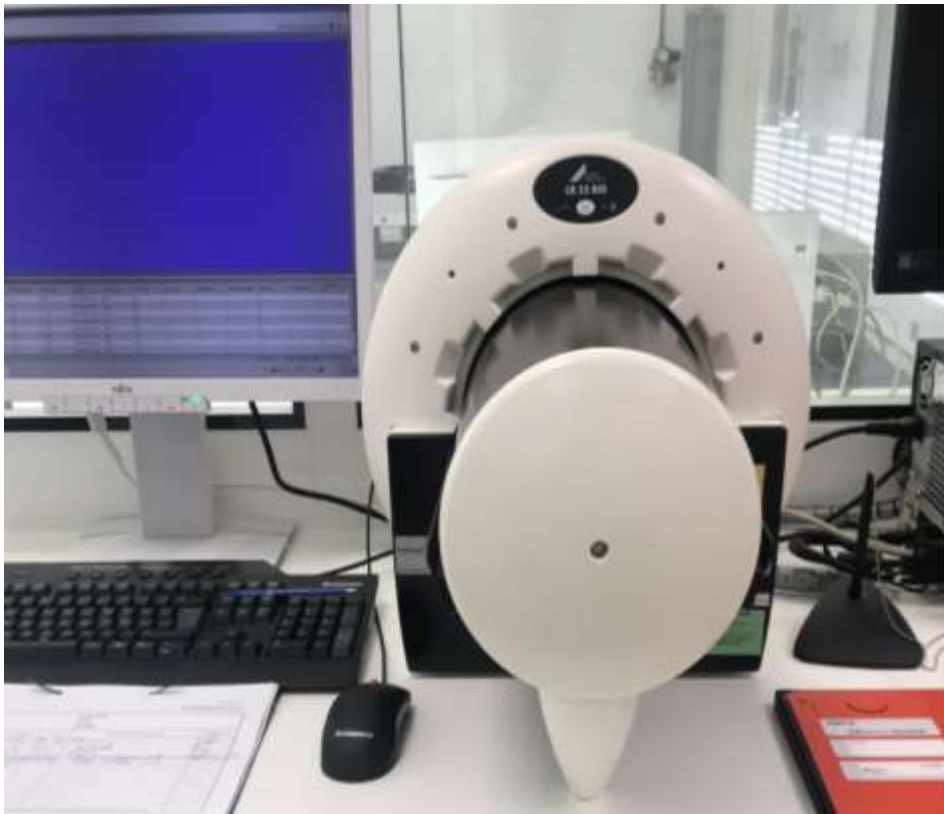
圖 116、巴特貝爾卡中央醫院核醫藥局所使用的品管儀器，Biostep CR35 TLC 分析儀。(照片為作者於巴特貝爾卡中央醫院拍攝)
