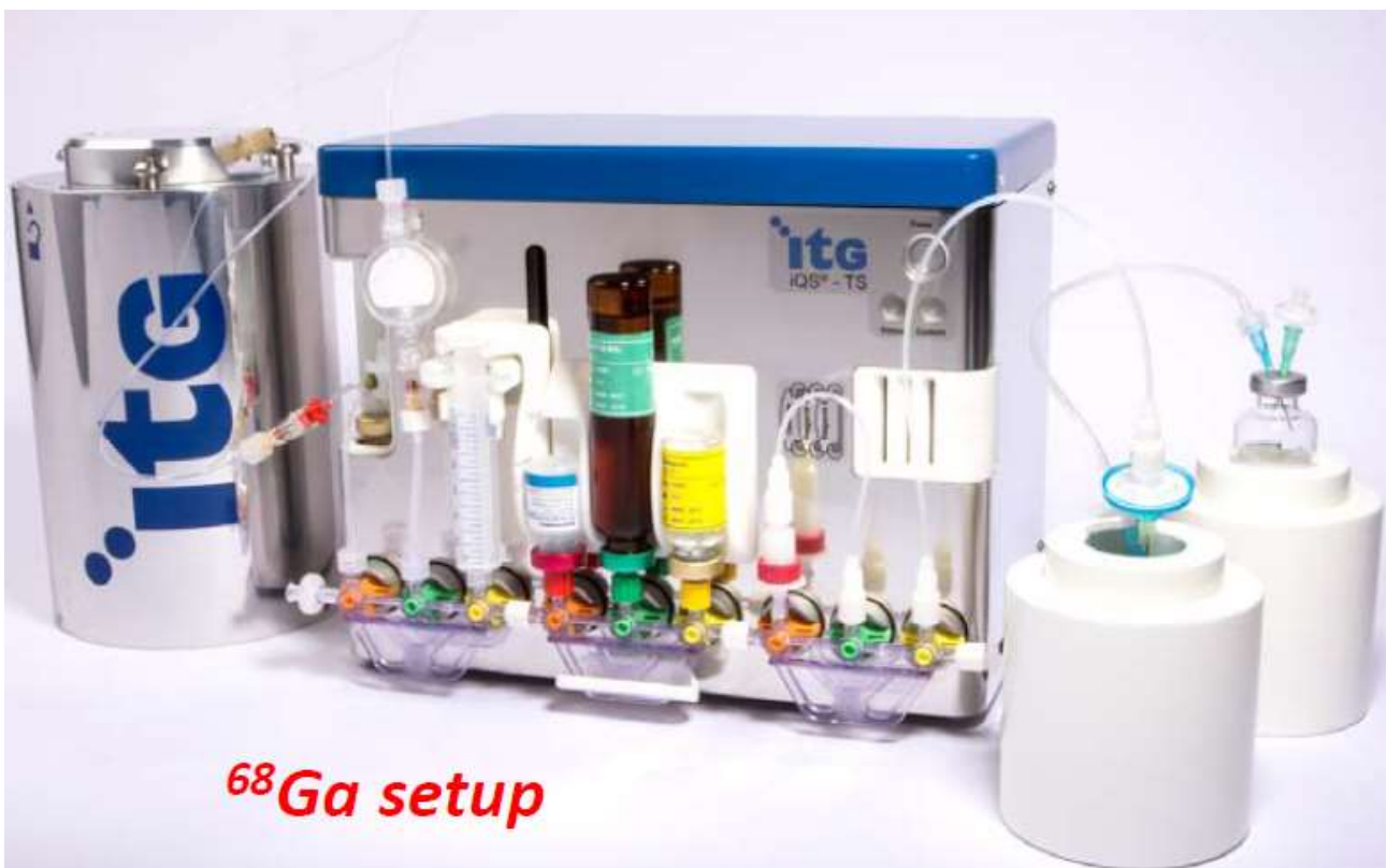
圖34、iQS-TS自動合成盒連接Ge-68/Ga-68發生器準備標誌核醫藥物。其依不同顏色來對應胜肽樣品、0.9 %氯化鈉溶液以及注射水瓶，耗材組以卡榫對應避免誤裝。(圖片摘錄自ITG型錄)
