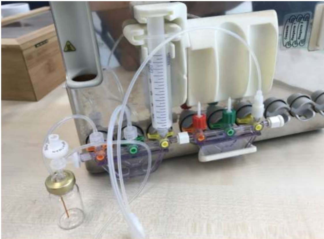
圖39、ITG iQS-TS系統在耗材組中設計一個針筒，做為控制其封閉系統內溶液之混和與流動控制，下方三下閥旋鈕各自獨立，可控制溶液之流向。(作者於ITG實驗室拍攝)
