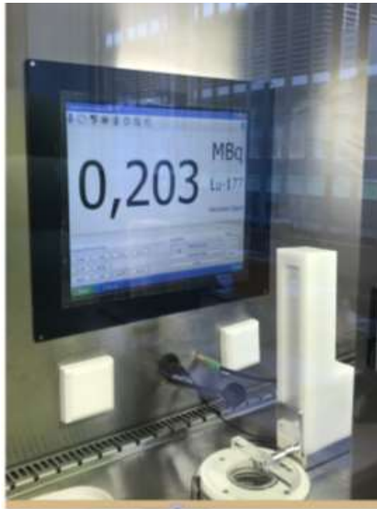
圖80、凱薩琳醫院核醫藥局內的輻射劑量校正儀，檢測核醫藥物從iQS-TS系統最終產品瓶轉移到給藥裝置後，最終產品瓶內殘留的輻射活度。(照片為作者於凱薩琳醫院拍攝)
