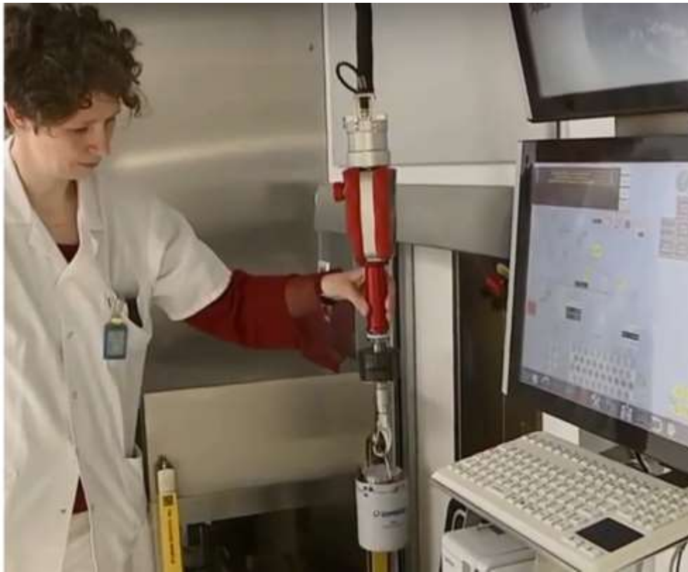
圖 123、醫事人員將分裝完成並裝入鉛罐的核醫藥物以機械吊臂吊起。(圖摘錄自巴特貝爾卡中央醫院專訪影片)
