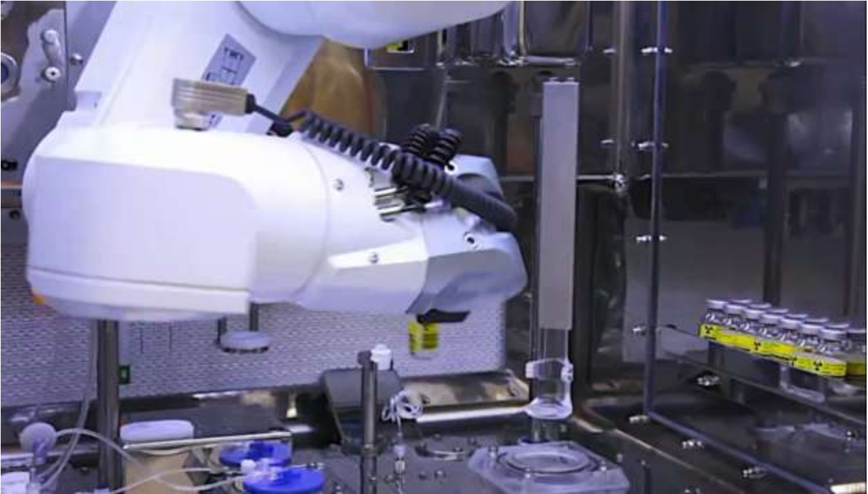
圖25、ITG實驗室內將分離純化出的n.c.a Lu-177射源以自動分裝器依照客戶需求活度分裝。(圖片摘錄自ITG介紹影片)
