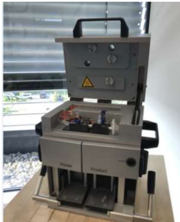
圖36、ITG第一代iQS設計，僅用以合成Ga-68核醫藥物。(作者於ITG實驗室拍攝)
