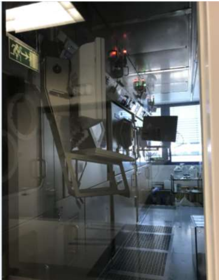
圖23、ITG純化分離實驗室鉛室。(照片為作者參訪ITG實驗室時拍攝)
