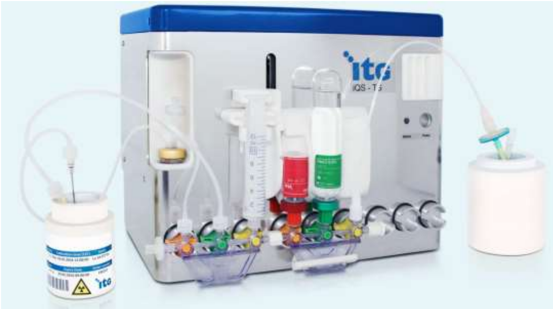
圖35、iQS-TS自動合成盒連接Lu-177射源合成核醫藥物。耗材組與Ga-68相比少一側卡樺可作為明顯區別，其他試劑組顏色標記相同，最終產物通過0.22 \mu\text{m} 濾膜作為最終滅菌。(圖片摘錄自ITG型錄)
