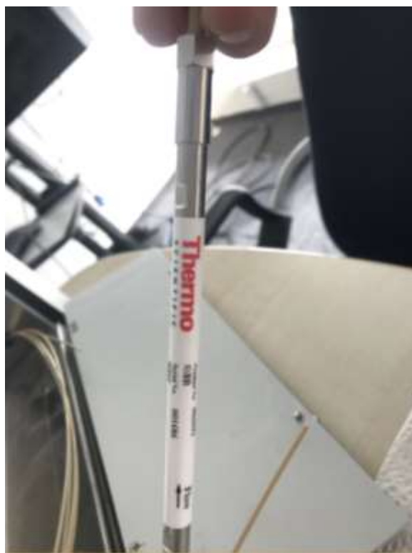
圖53、ITG radioHPLC所使用的管柱為Thermo C-18管柱。(作者於ITG公司實地操作時拍攝)
