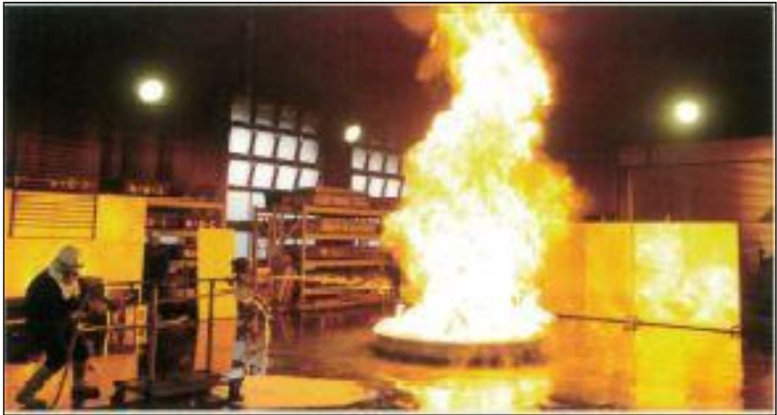
圖 9：低發泡泡沫滅火試驗
