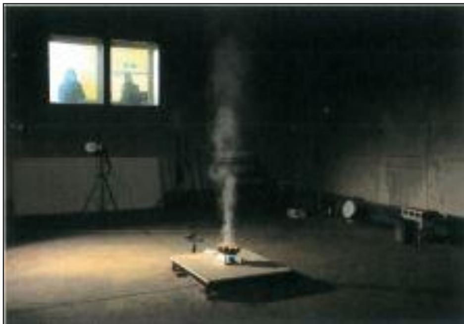
圖 10：偵煙探測器試驗
