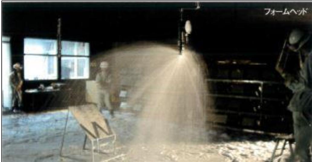
圖 17：泡沫滅火設備試驗
