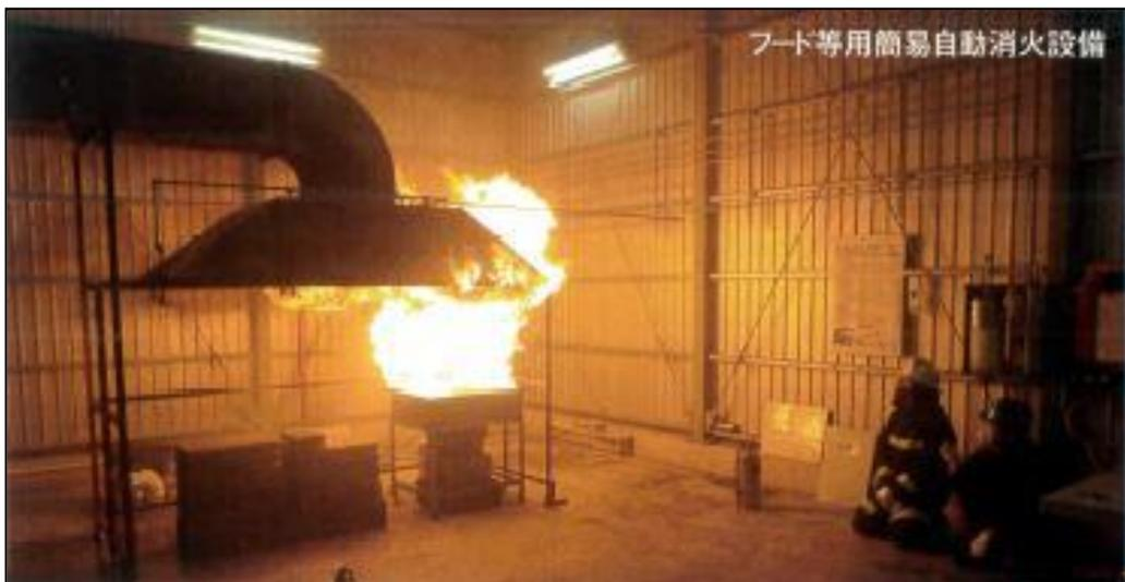
圖 18：簡易自動滅火設備試驗
