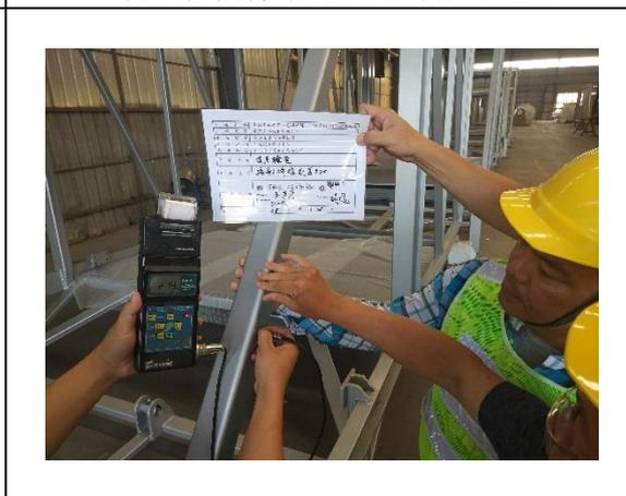
20 號旅客橋接船通道面漆膜厚量測
