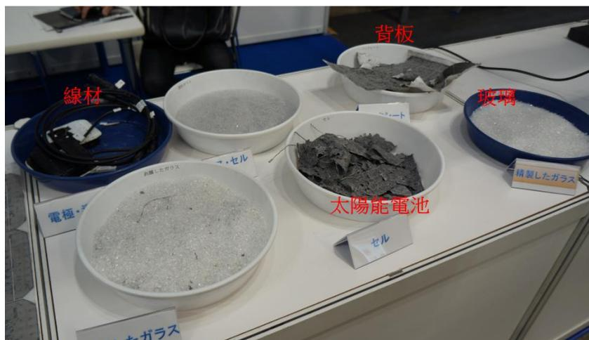
圖 28 太陽光電模組經過分離後之回收材料
