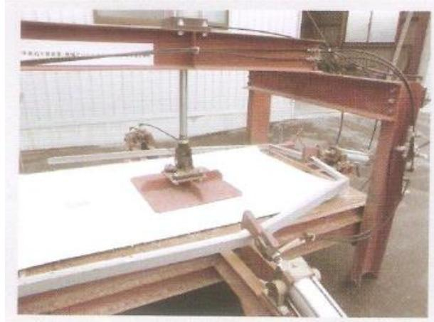
圖 27 模組拆解(a)分離接線盒、導線
