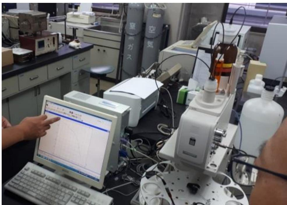
圖 6：水泥中氯離子自動滴定儀
