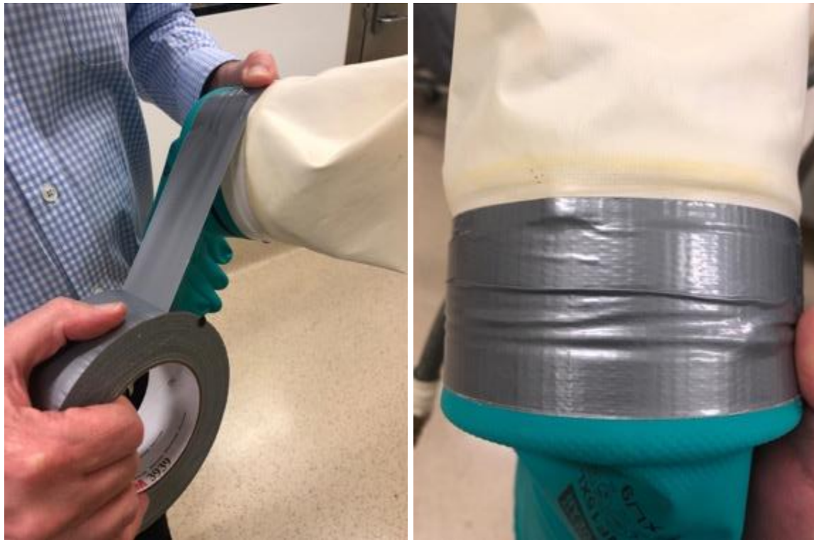
圖 8. 手套封上膠帶，確認無任何垂直摺痕。
