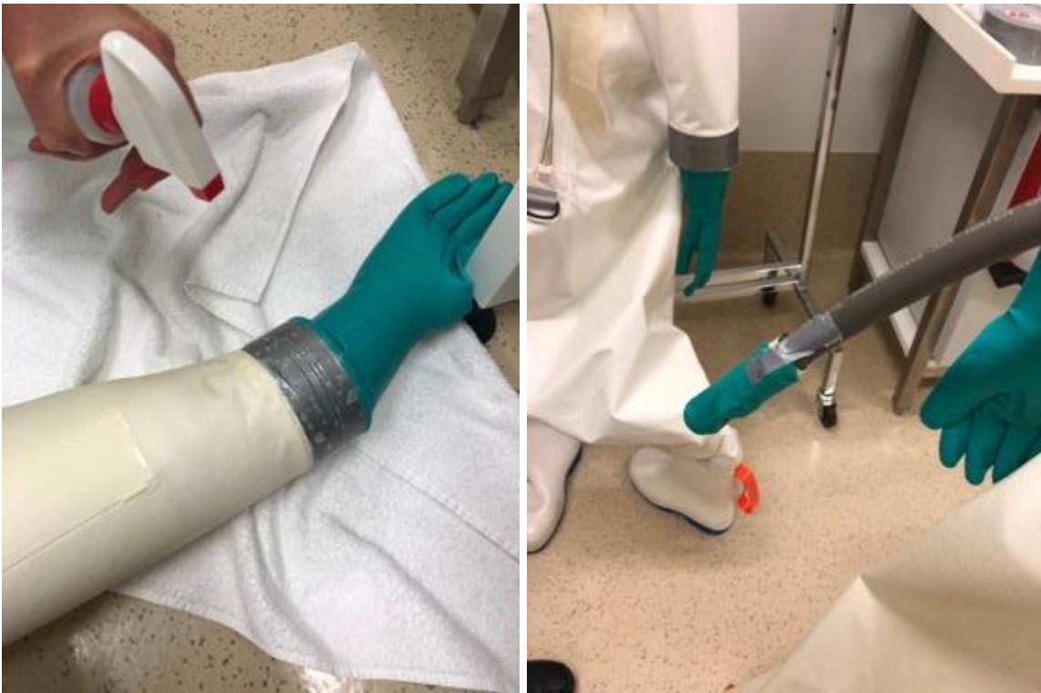
圖 11.以肥皂水進行洩漏測試，測試後將供氣接口保護。
