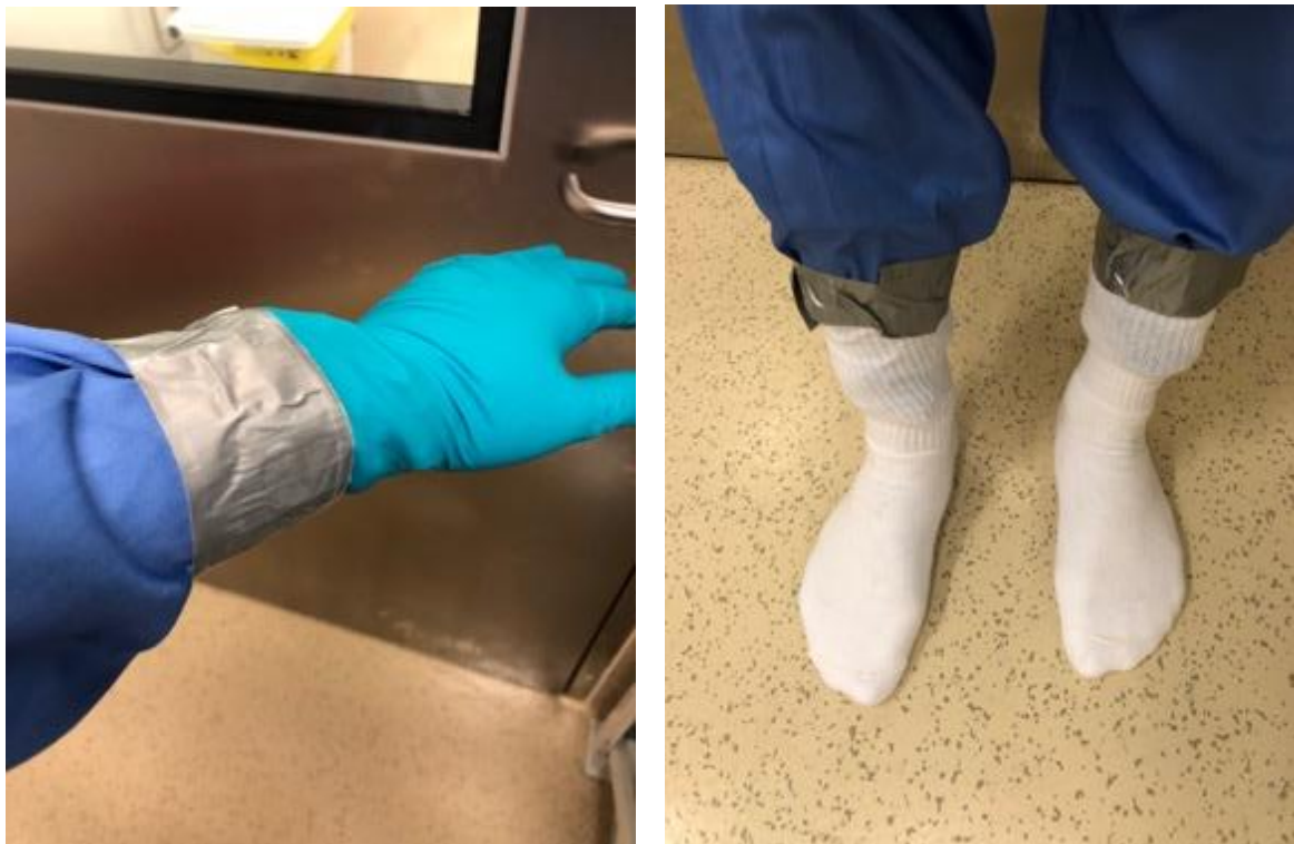
圖 12. 手套及襪子均使用膠帶密封。
