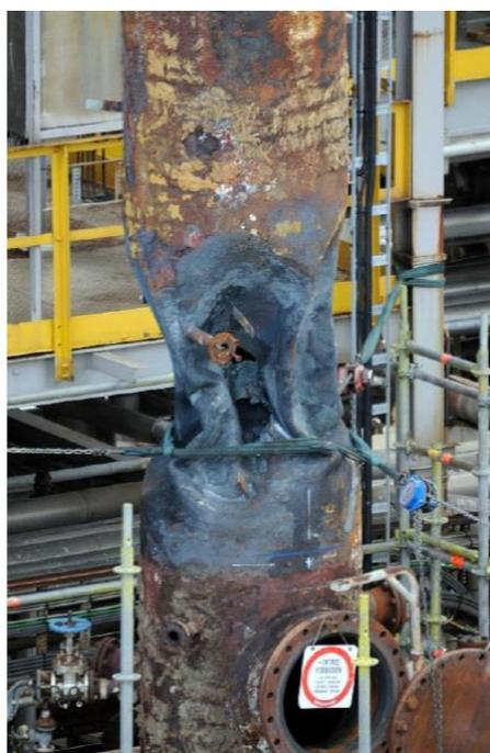
圖 7. 爆炸事例之真空塔損毀外觀
