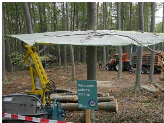
圖 175 作業區上方防護網的安全設計
