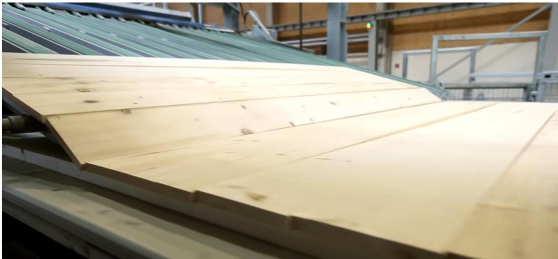
圖 191 步驟 3 堆疊直交的第二層，再重複步驟 1 至 3 直到所需厚度
