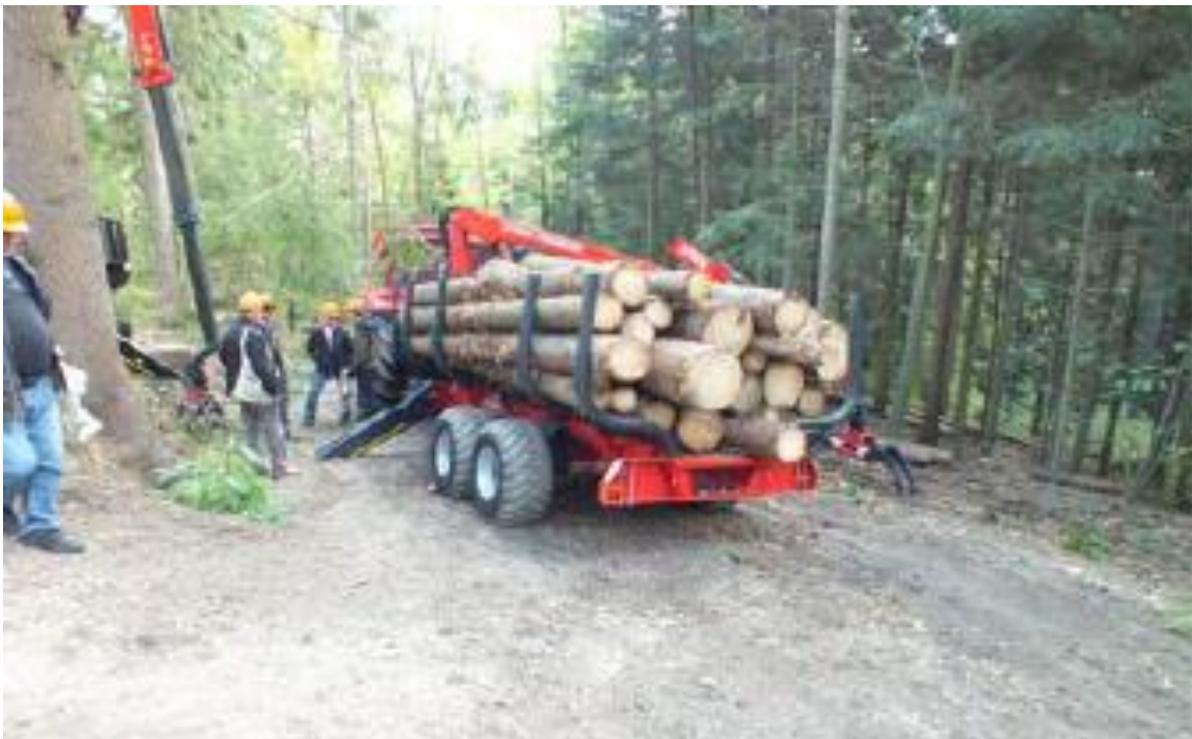
圖 157 裝載式地面集運材車(Fordwarder)適用造材好的原木搬運，可載運較遠的距離
