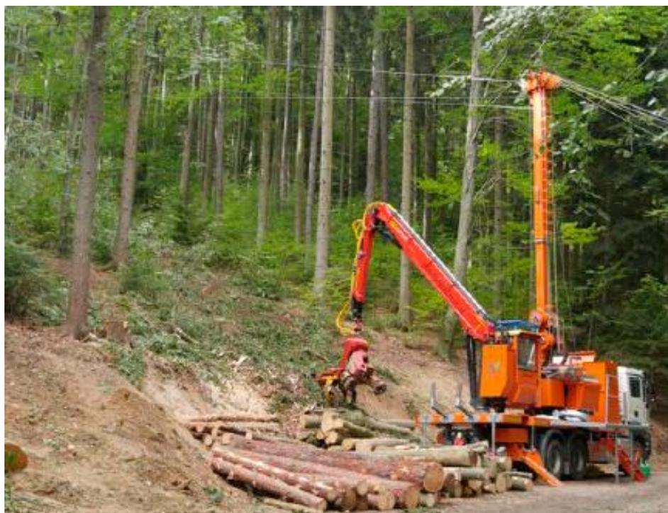
圖 161 不同自走功能之塔式集材機(卡車式)
