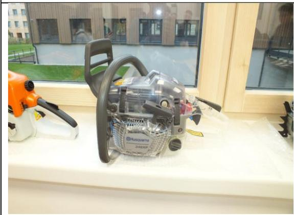
圖 35 透明機殼以便瞭解鍊鋸原理
