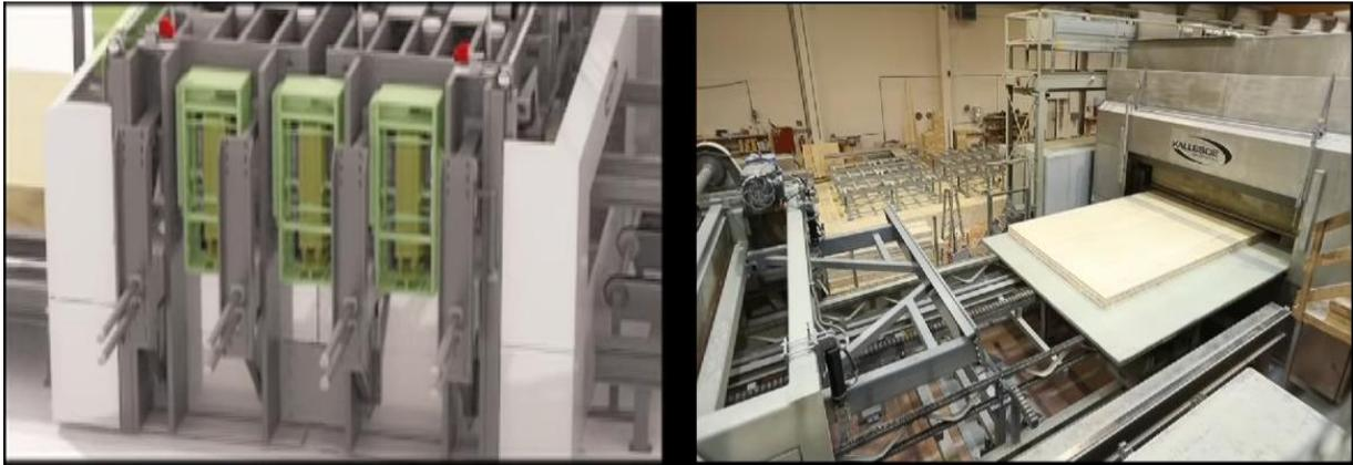
圖 194 利用高週波(左)加速膠合劑硬化
