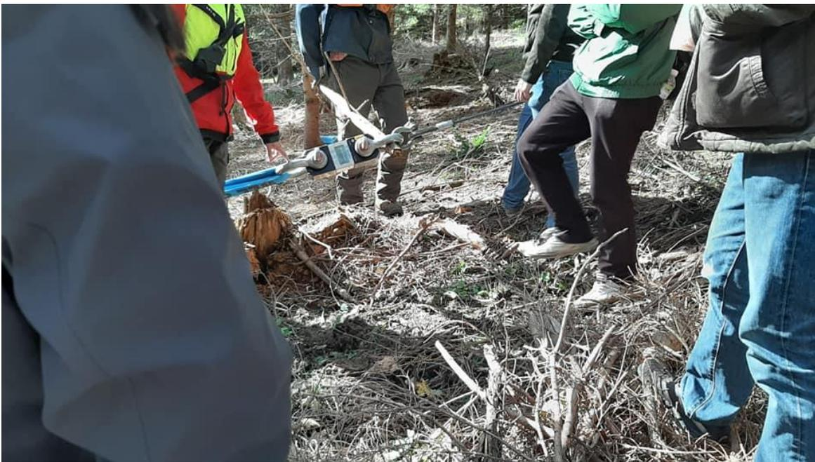
圖 145 利用引張器計算拉伸強度
