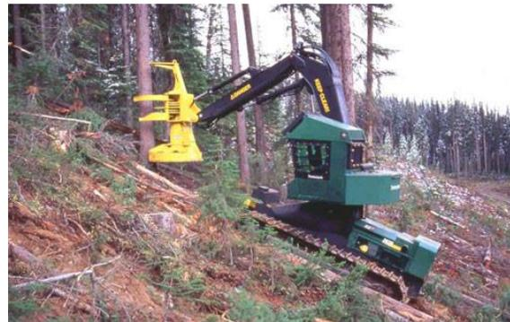
圖 153 單功能之伐木機(Feller)與雙功能之伐木聚材機(Feller buncher)
