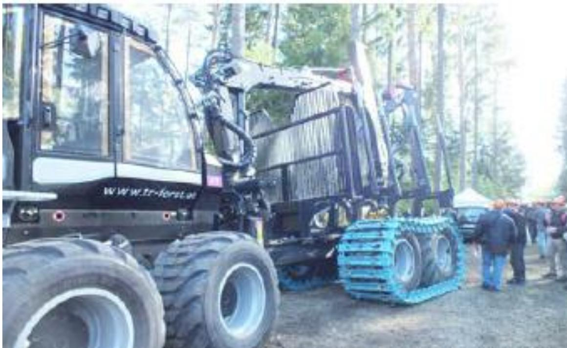
圖 158 輪胎式與履帶式集材機
