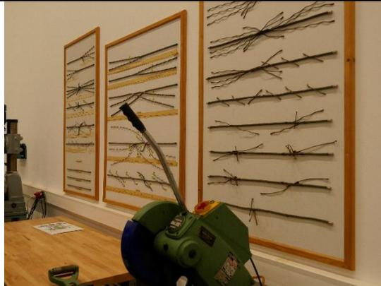
圖 46 維修室-鋼索維修圖示
