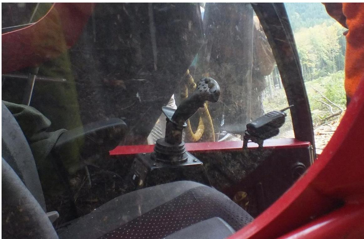
圖 130 左手邊為塔式集材機無線通訊與造材加工機搖桿
