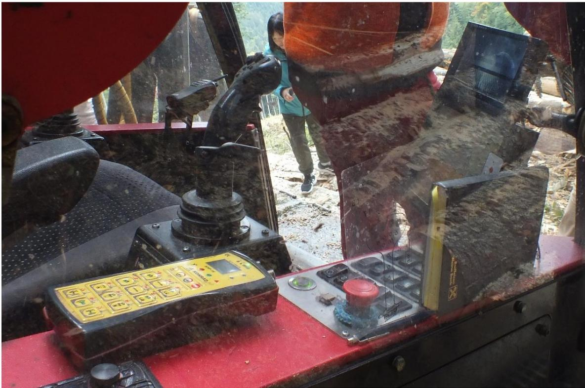
圖 129 右手邊為造材加工機操作面板與搖桿及塔式集材遙控器
