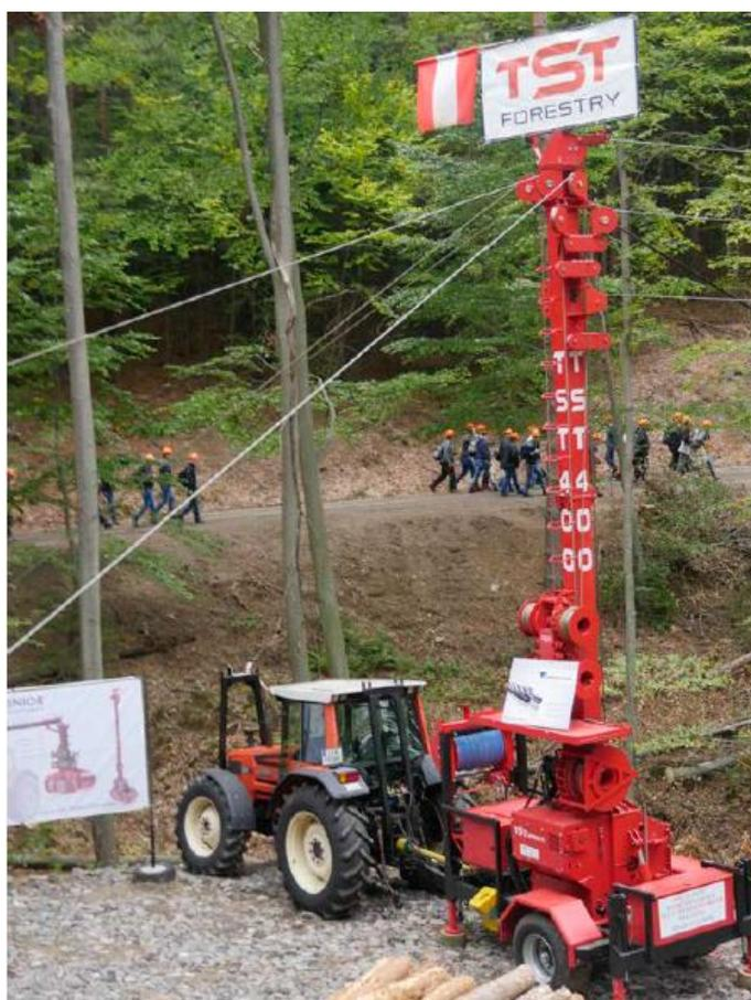
圖 162 不同自走功能之塔式集材機(曳引機式)
