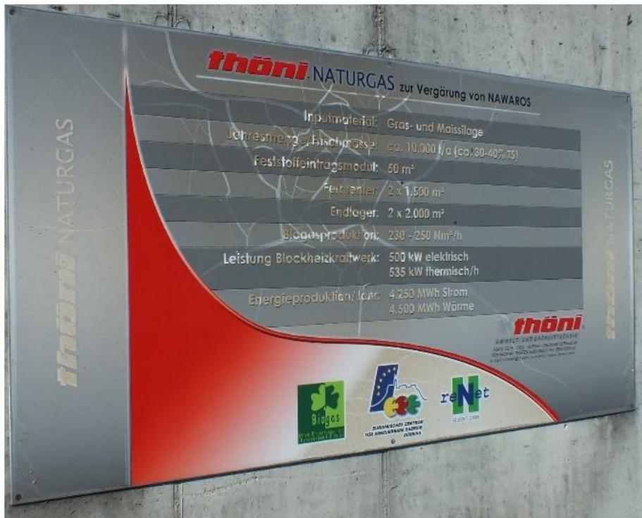
圖 218 沼氣發電廠廠區資訊(包含廠區面積、發電量、產氣量等)
