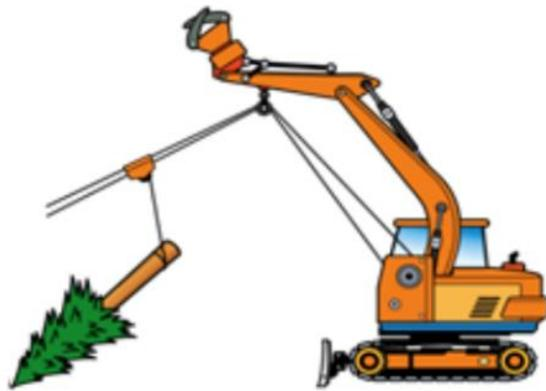
圖 160 塔式集材機與迴旋式集材機示意圖
