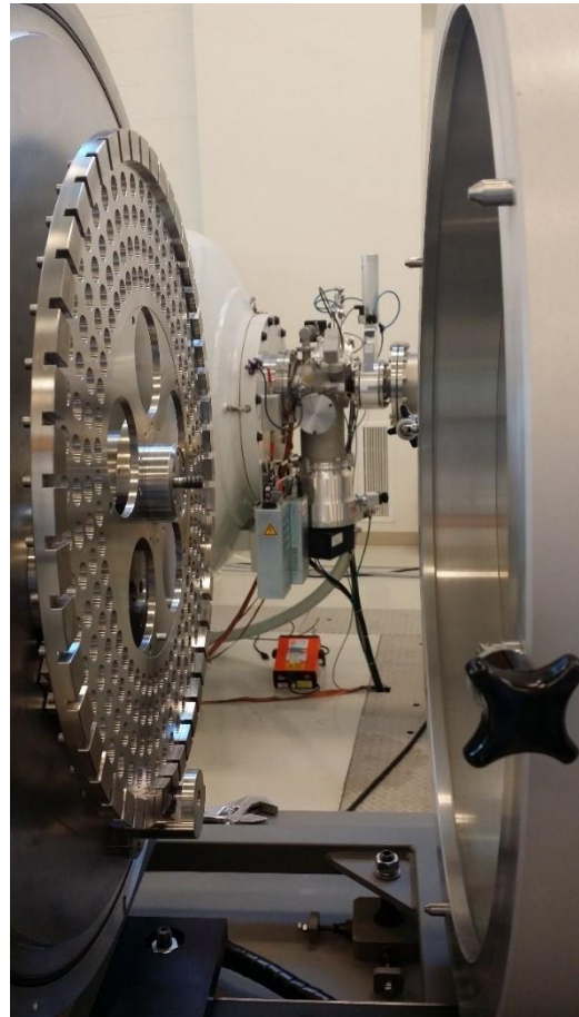
圖 2.34 AMS 圓形樣品靶轉盤分離
