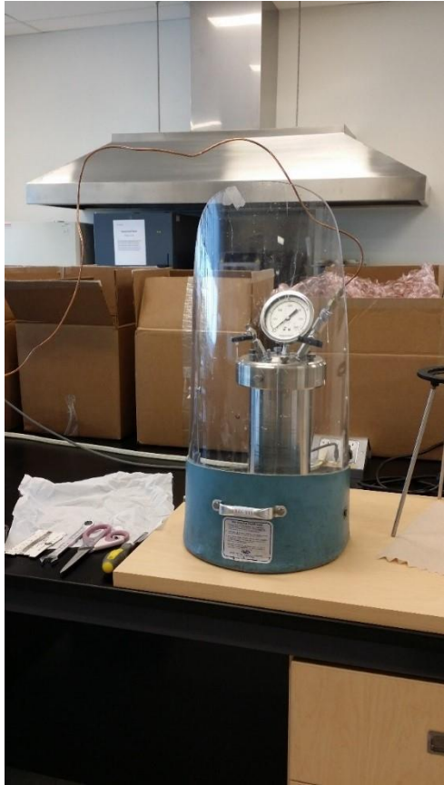
圖 2.30 含氣的固體樣品燃燒筒
