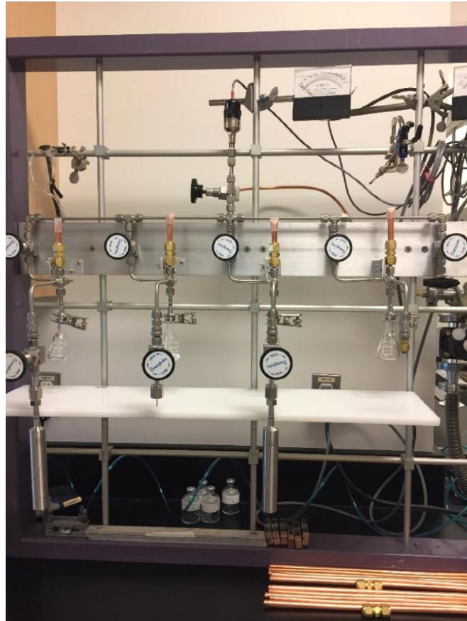
圖 2.25 惰性氣體元素純化設備
