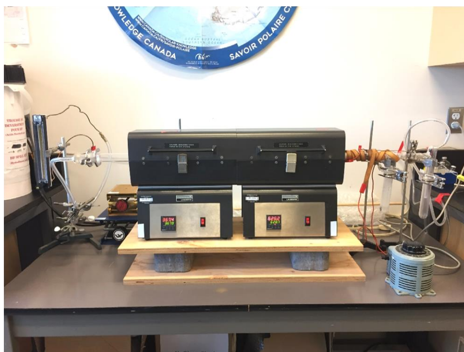
圖 2.10 碘 129 固體樣品分析燃燒設備
