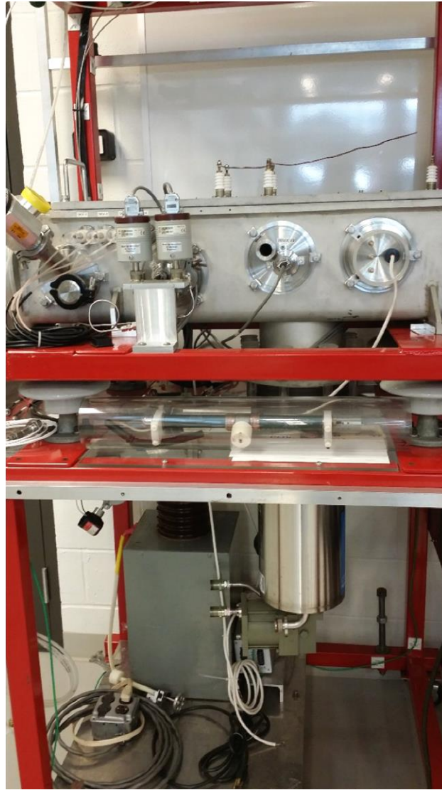
圖 2.32 分離銫 135 化學反應分離設備
