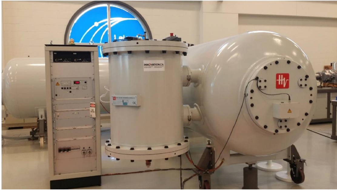
圖 2.38 AMS 高壓電供給及絕緣設備
