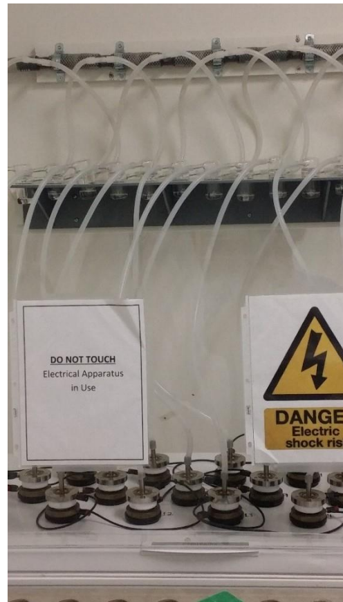
圖 2.8 水樣中氘電解濃縮理設備
