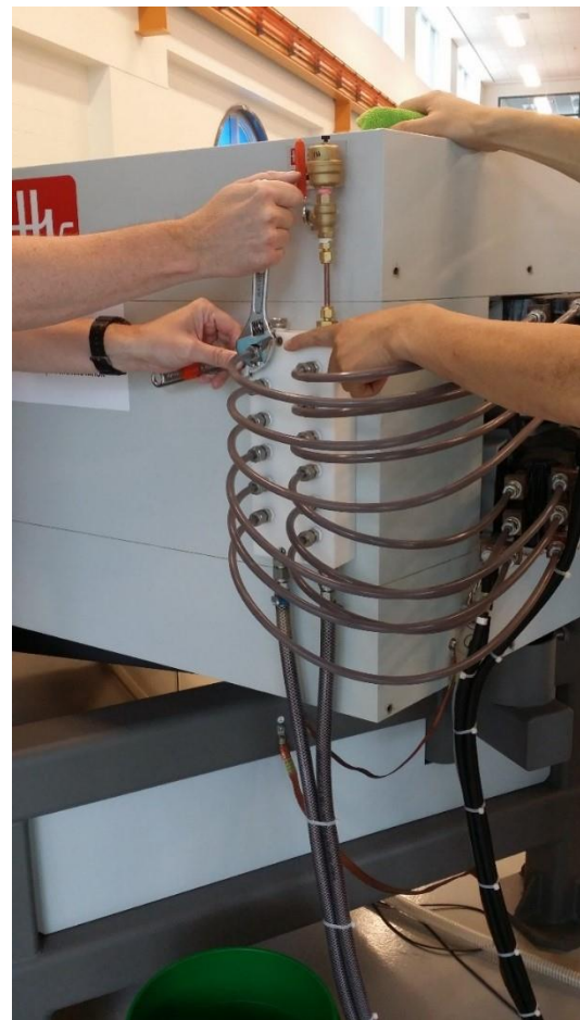
圖 2.42 AMS 磁場分析器冷卻循環水
