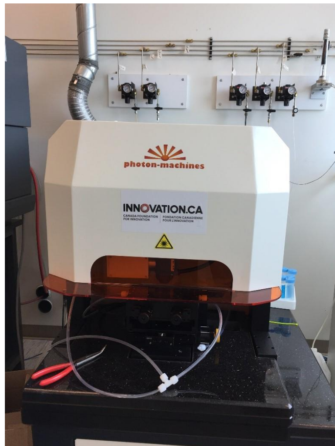
圖 2.47 連接 ICP-MS 之雷射剝蝕前處理設備
