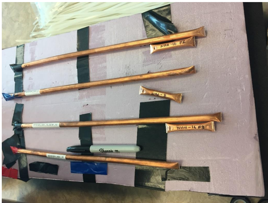
圖 2.26 惰性氣體元素採樣收集管
