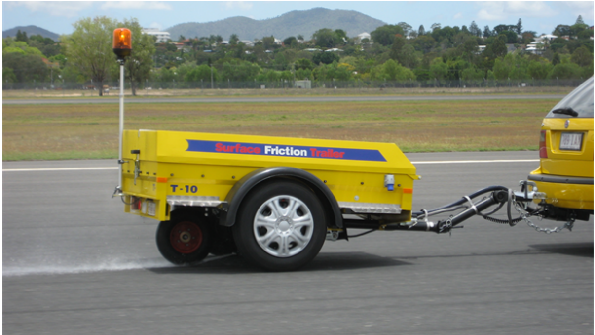
圖 3-5、連續摩擦力量測設備(Continuous Friction Measurement Equipment，CFME)
