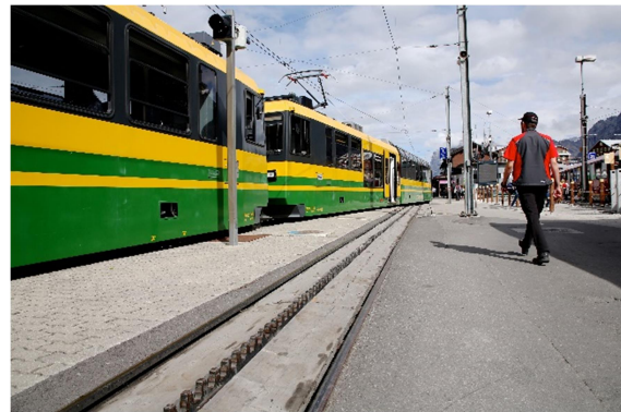
溫根阿爾卑斯鐵路在軌距間鋪設木板顧慮行人穿越時的安全
