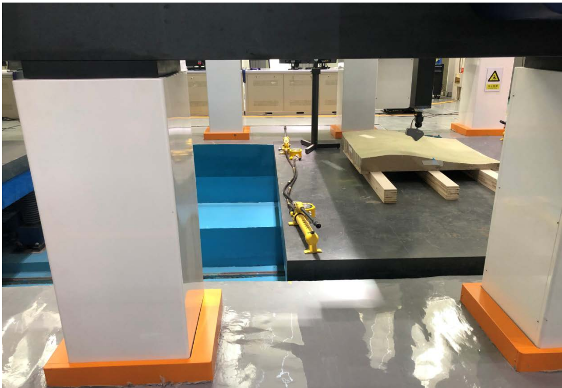
圖 6、模型掃描機及震測採集機，左後方藍色處為水槽
