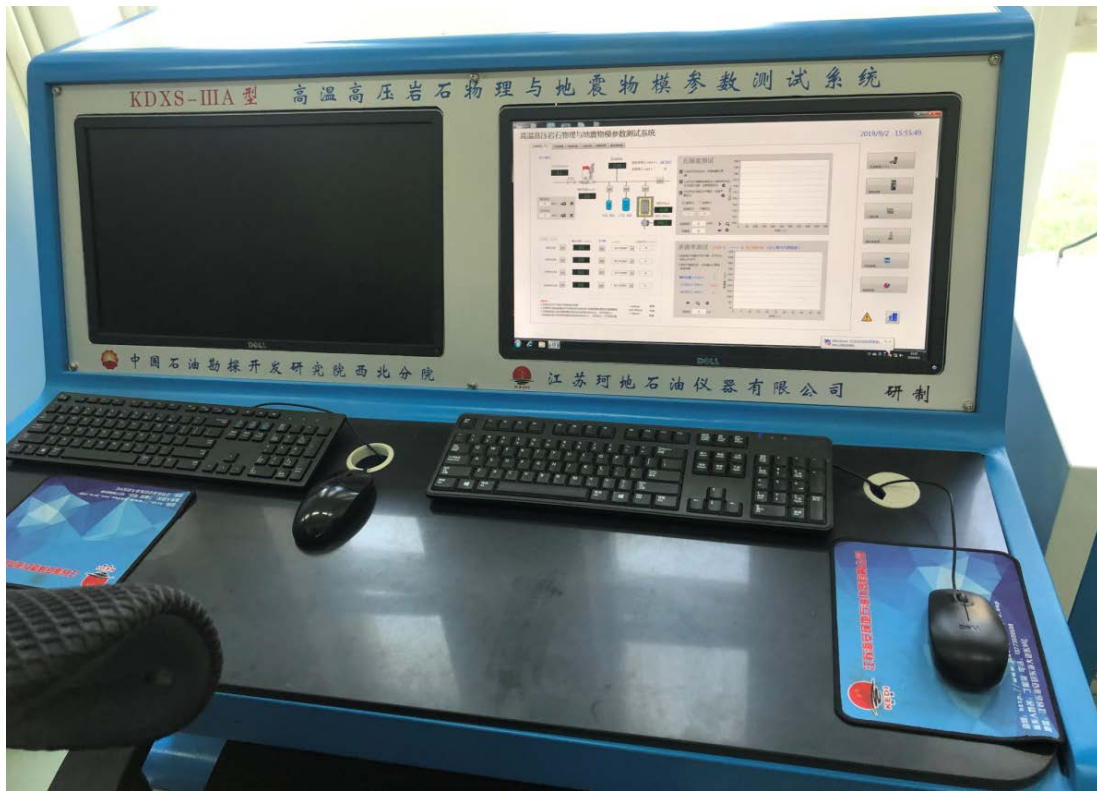
圖 11、高溫高壓岩石物理與震測物理模擬參數測試系統
