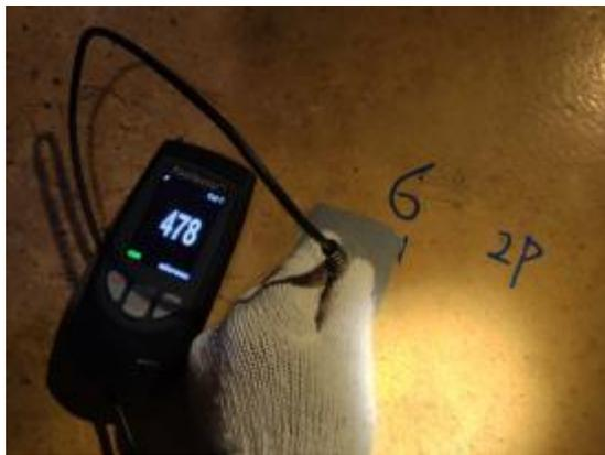
貨油艙油漆修補膜厚量測
