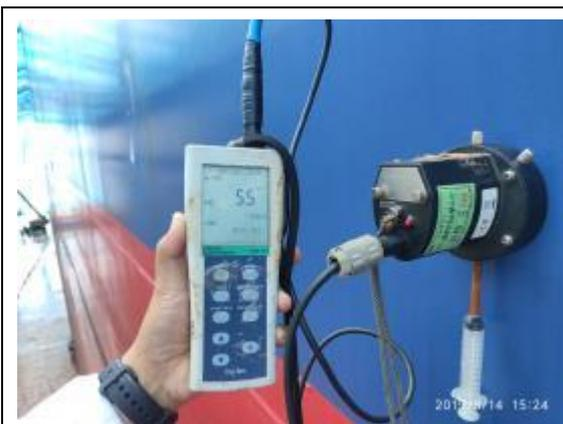
清洗船體後量測鋼板表面塩份
