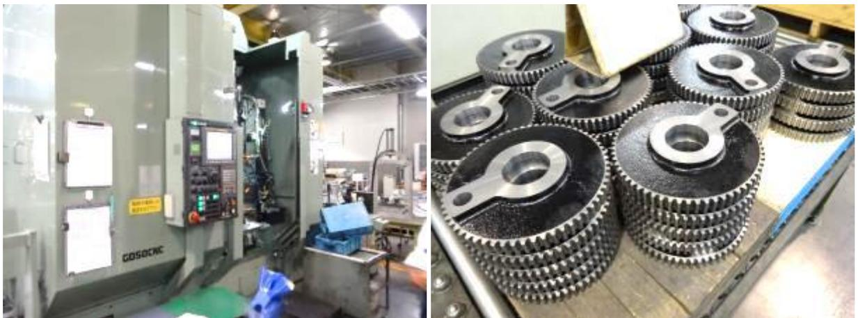
圖 19 齒輪加工設備(CNC)及半成品
