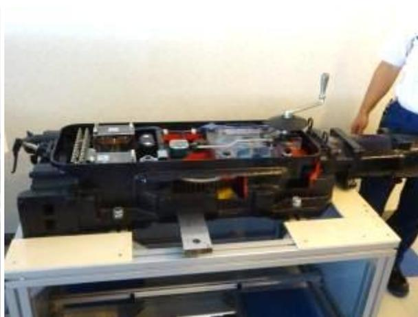
圖 13 NS-AM 型電動轉轍器機構展示（非使用於臺鐵之型式）
