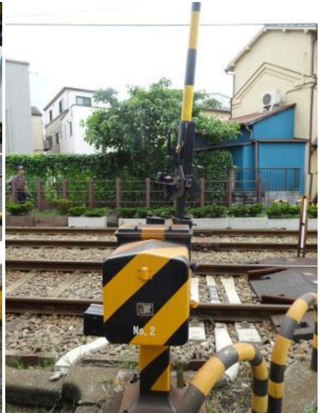
圖 40 2號平交道設置京三製作所之遮斷機。
