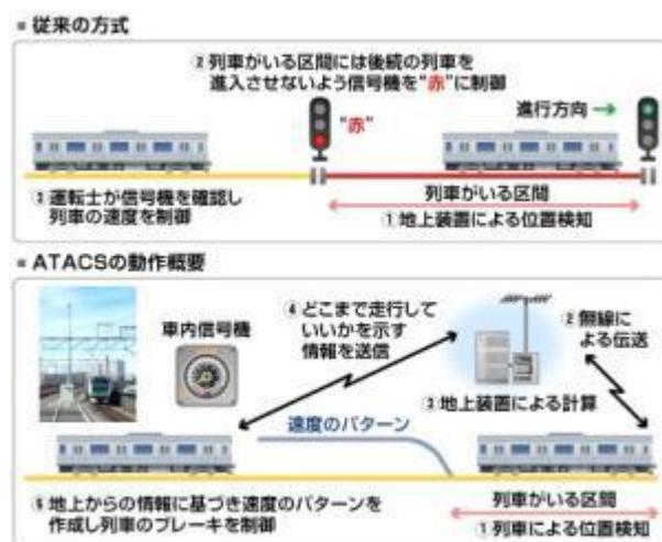
圖 24 ATACS 示意圖 (取自 JR 東日本鐵道公司網站)
