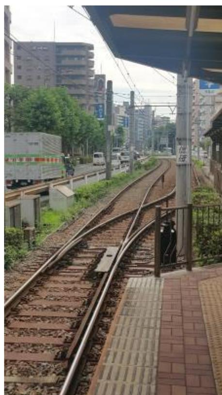
圖 45 「早稻田」站折返線設置可擠式機械轉轍器。
