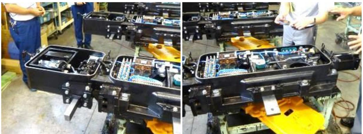
圖 20 轉轆器組裝及檢查作業區（臺鐵路號誌工程案使用之批次）
