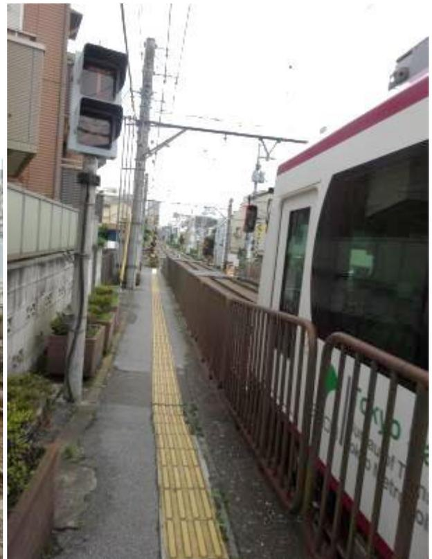
圖 42 平交道尚未遮斷防護時，號誌機顯示「X」燈號。
