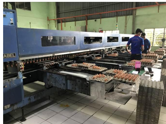
雞蛋轉動翻轉機構設計與雞蛋分級自動化設備
