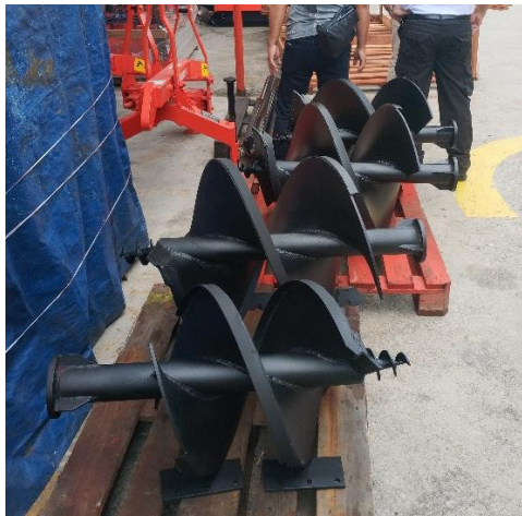
曳引機附掛式挖洞器鑽頭，其可挖出約人身寬的大洞，方便當地種植或移植大型經濟樹木。
