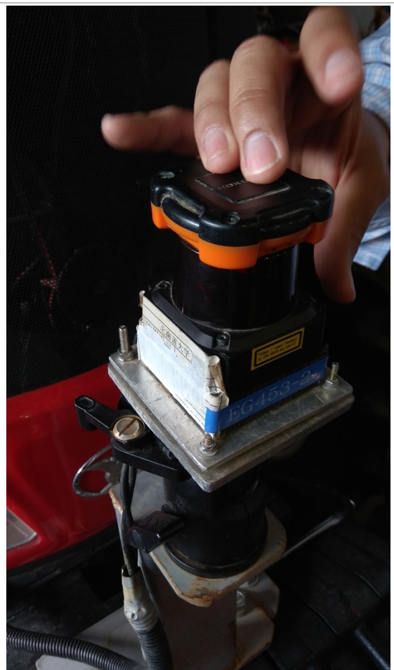
圖 10、Ricardo OSPINA 博士介紹曳引機前置避障 Lidar 感應器作用
