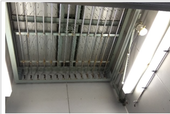
圖 23、技術中心模擬淋雨對藥效影響之實驗設備
